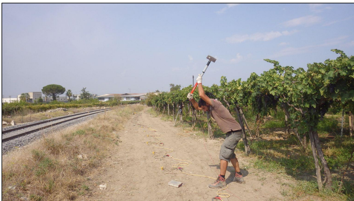
Fig. 49 – Energizzazione in onde P lungo il profilo sismico a rifrazione S5-6.
