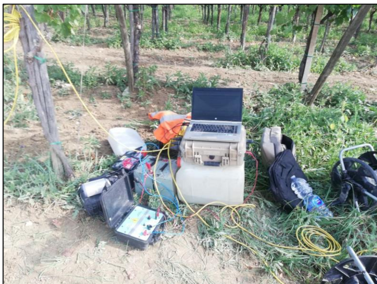
Fig. 47 – Strumentazione con georesistivimetro del tipo MANGUSTA SISTEM MC 96/E (a sinistra) e particolare di stendimento elettrodo (a destra).
