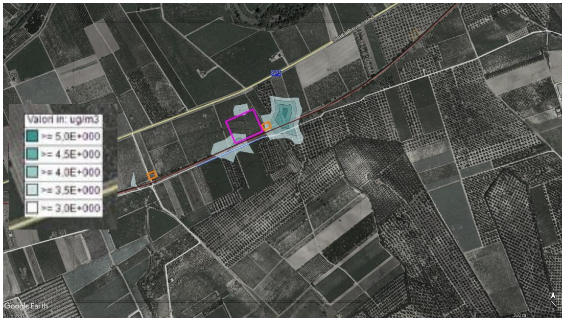
Figura 6-23 Concentrazioni di PM_{10} dovute alle emissioni dei mezzi d'opera dell'area 1A
