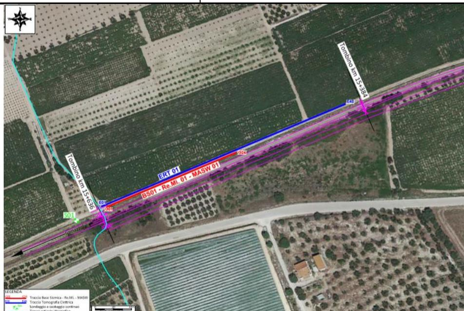
Figura 12-4. Stralcio dell'ubicazione planimetrica delle indagini MASW01, RE.MI.01 (RFI).
