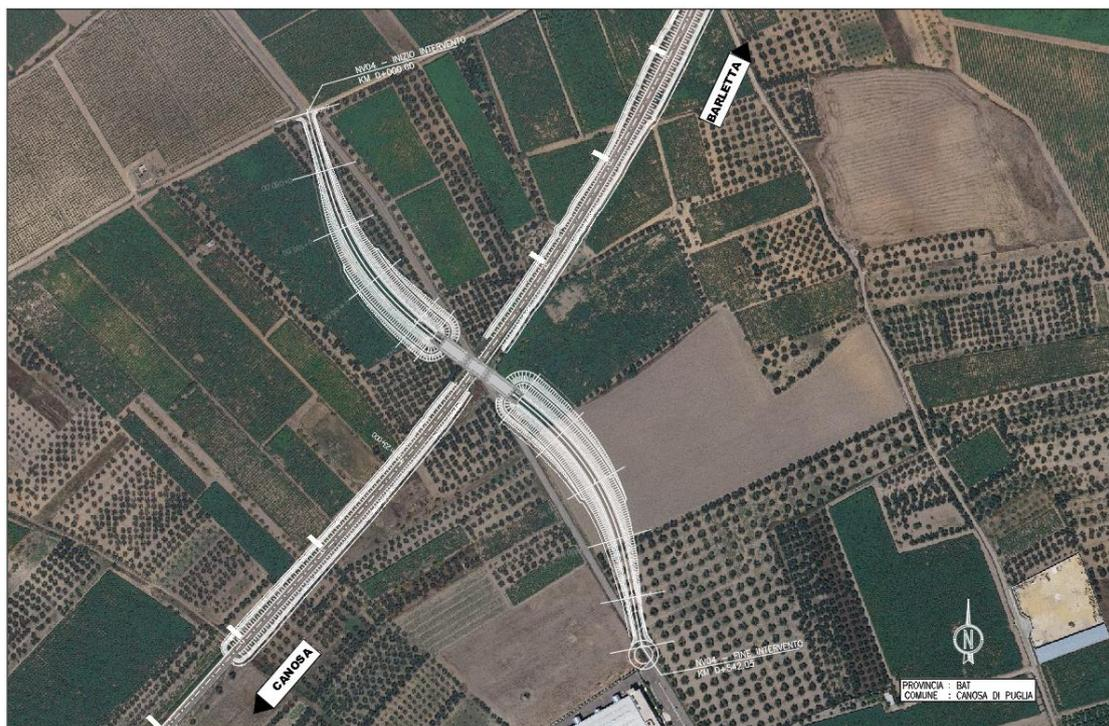
Il nuovo CVF si realizza in sostituzione del PL esistente alla progressiva di progetto 22+903 (km LS 22+897), e nell'immagine di seguito sono rappresentati i percorsi di ricucitura che garantiscono anche alla viabilità interessata dal PL07 (prog progetto 17+700; km LS 17+697) le manovre e le percorrenze attualmente esistenti.
