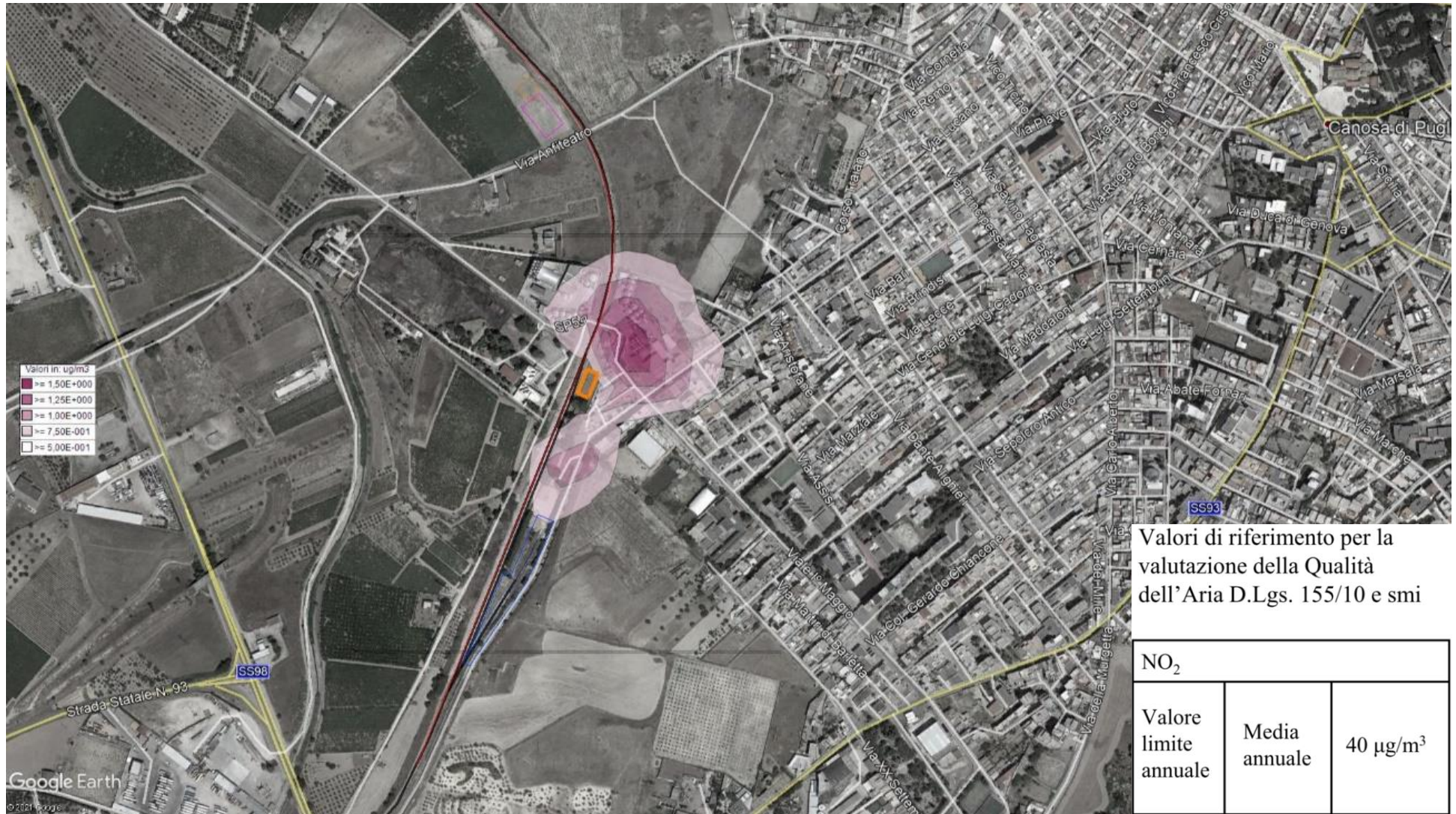
Concentrazioni di NO x dovute alle emissioni dei mezzi d'opera dell'area 2 (AT.42)
