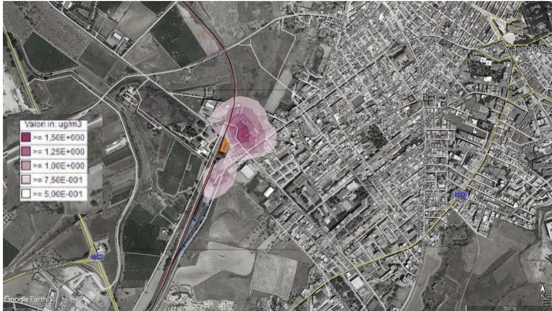
Figura 6-28 Concentrazioni di NO x dovute alle emissioni dei mezzi d'opera dell'area 2 (AT.42)
