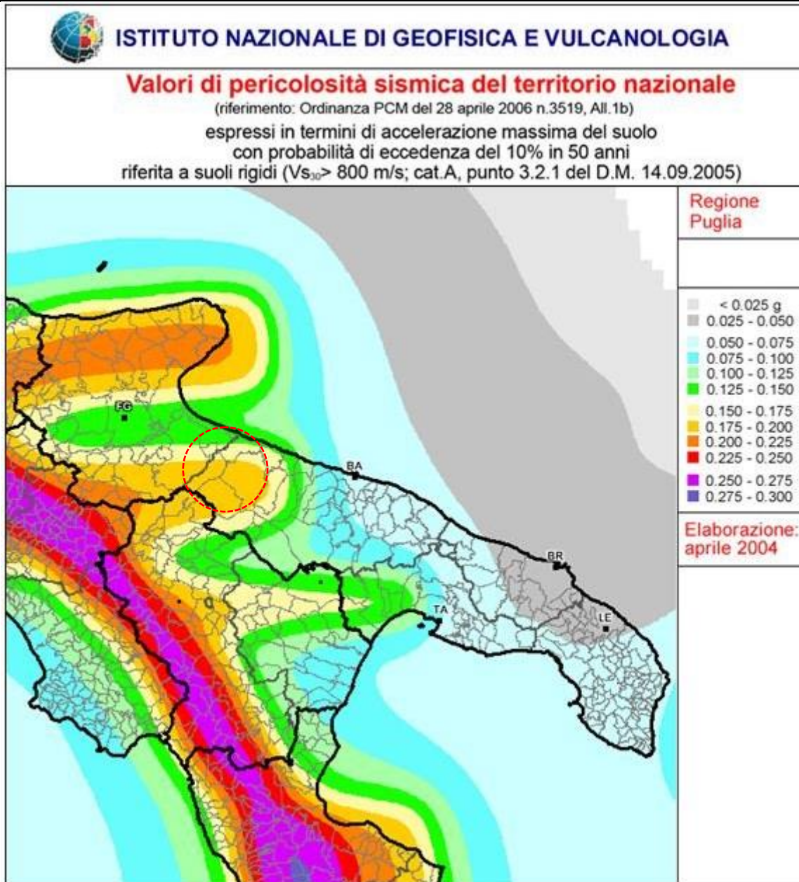
Figura 12-3 Mappa di pericolosità sismica della Regione Puglia espressa in termini di accelerazione massima del suolo ( a_{max} ) con probabilità di eccedenza del 10% in 50 anni riferita a suoli molto rigidi ( V_{s30} > 800 m/s) – da INGV riferita a suoli molto rigidi ( V_{s30} > 800 m/s) – da INGV.
