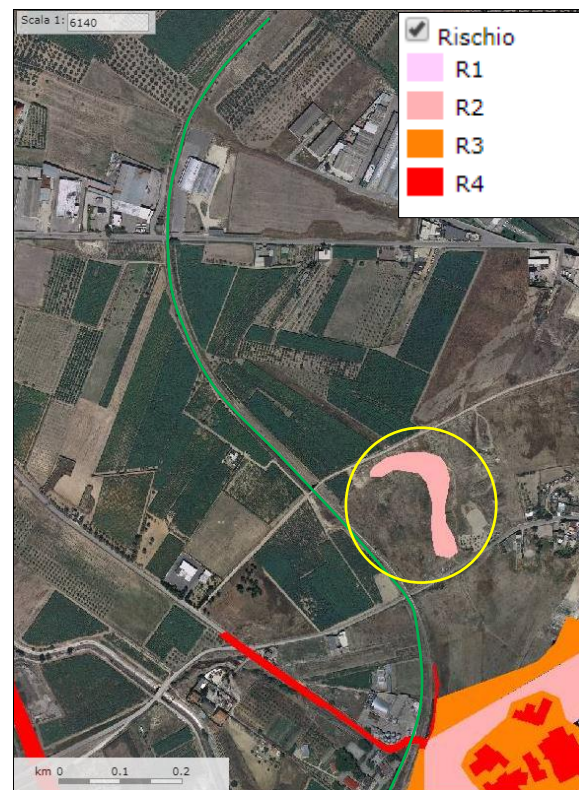
Figura 10-11 Rischio geomorfologico dell'area tra le pk 24 +200 ÷ 24+400 (in giallo). In verde il tracciato ferroviario.
