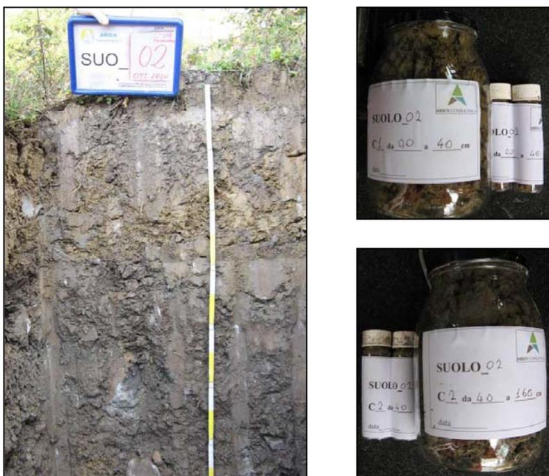
Particolare profilo di suolo e dei campioni C1 e C2 prelevati presso la stazione di monitoraggio di suolo SUOLO\_02
