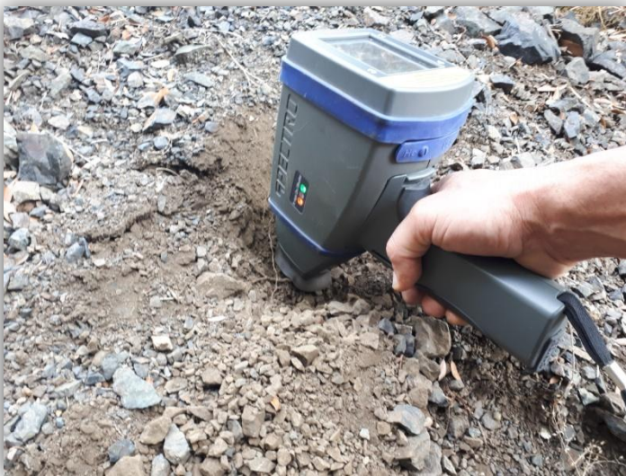
Prospezione mediante Spettrometro XRF
