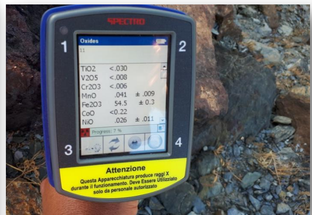
Prospezione mediante Spettrometro XRF
