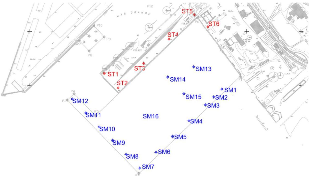
**Figura 1. Ubicazione sondaggi a terra V sporgente e a mare Est V sporgente – da Relazione Geotecnica del PROGETTO DEFINITIVO A BASE GARA (Figura 5.1 del doc. PUG102-PD-ED-008)**
