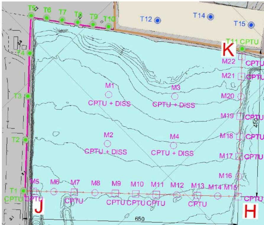
**Figura 3. Ubicazione planimetrica delle indagini geotecniche (sondaggi e prove CPTU) propedeutiche al Progetto Esecutivo (giugno-settembre 2015).**
