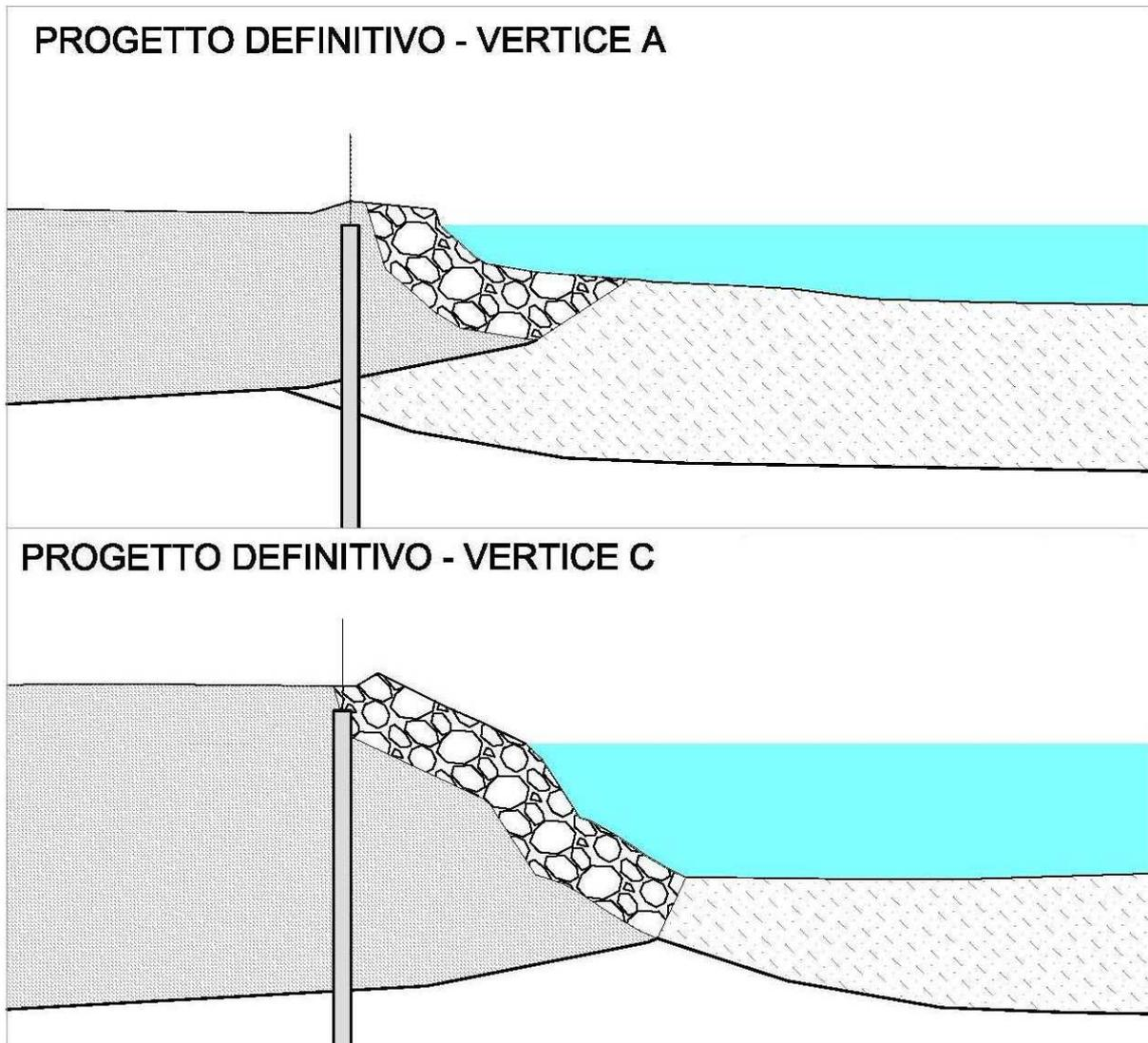
Fig. 5.1 –Ricostruzione della mantellata sulla base delle Sezioni del Progetto Definitivo
