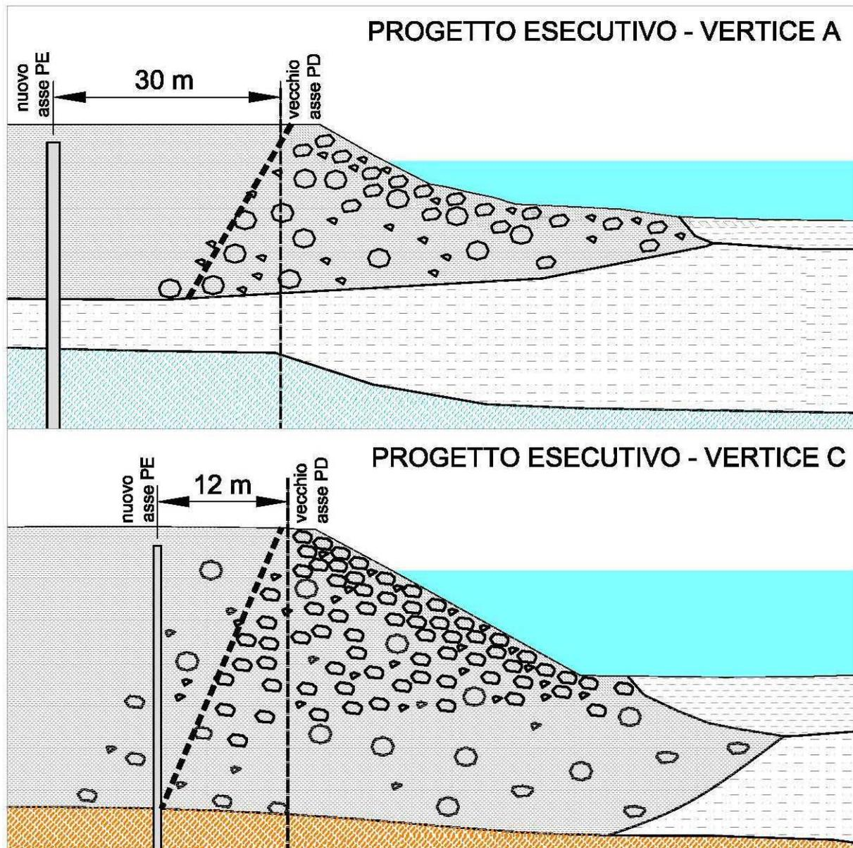
Fig. 5.2 – Sezione rilevata dalle indagini del Progetto Esecutivo
