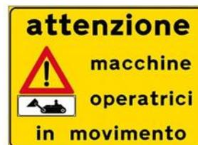
Le zone dove sono presenti macchine operatrici dovranno essere segnalate con cartelli di pericolo di presenza di macchine operatrici in movimento e divieto di passare o sostare nel raggio di azione delle stesse
