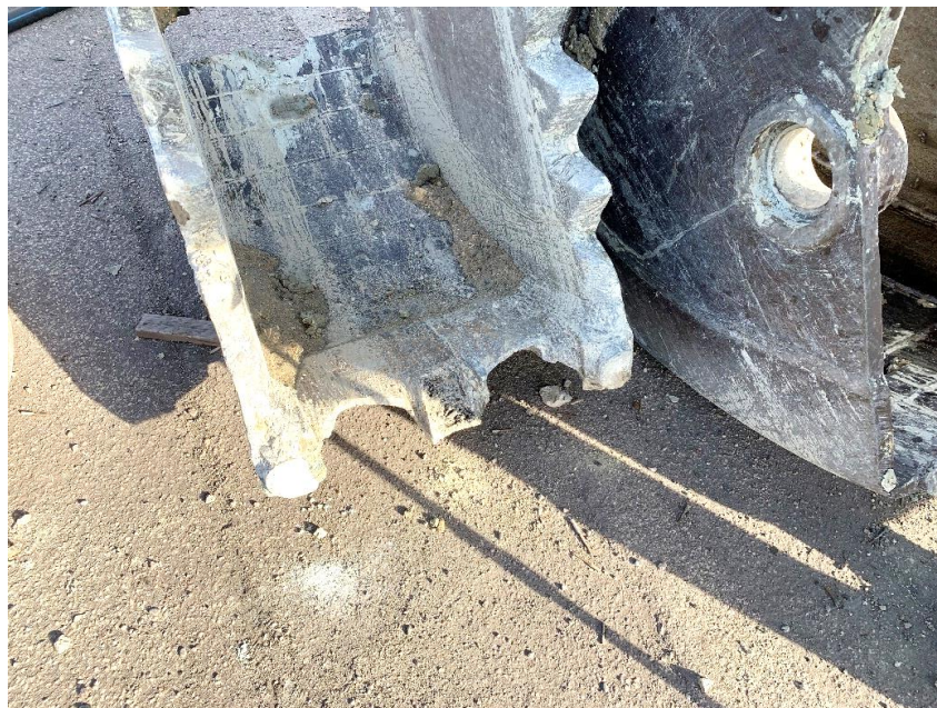
Figura 5. Valva della benna con supporti dei denti danneggiati e priva di denti
