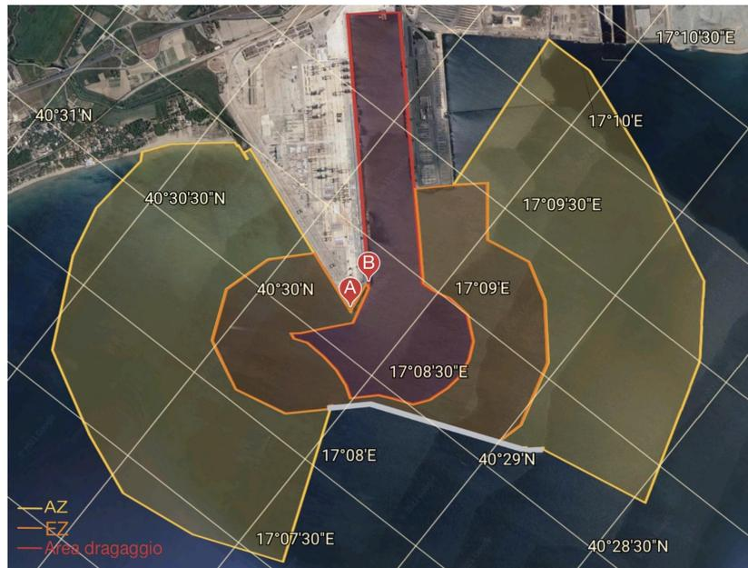
*Fig.17 - Estensione dell'area di dragaggio, dell'Exclusion Zone (EZ) e dell'Alert Zone (AZ); A e B rappresentano i due punti di osservazione.*
