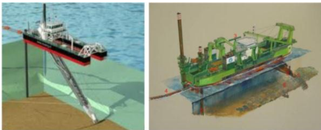
Figura 3.42 – Esempio di draga aspirante stazionaria (stationary suction dredgers – SD)
