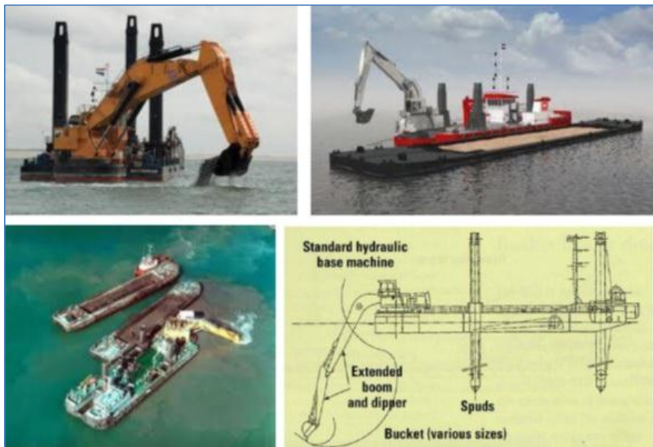
Figura 3.40 – Esempi di draghe a benna o a cucchiaio rovescio (backhoe dredgers – BHD)
