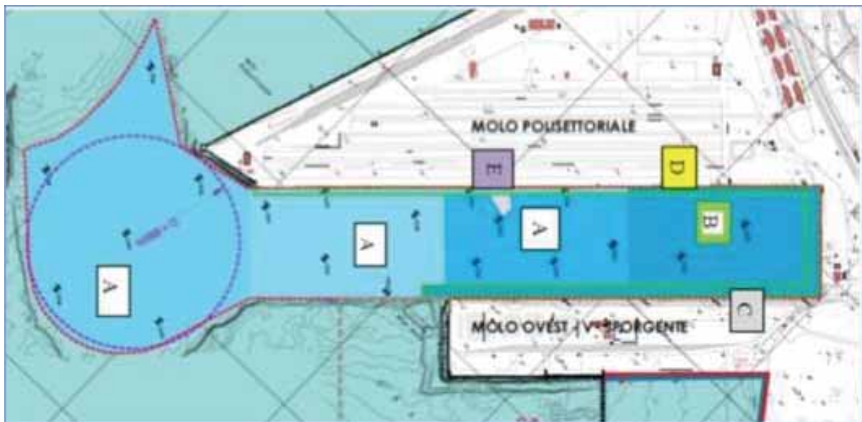
Figura 4.1 – Presentazione quote di dragaggio nei vari settori
