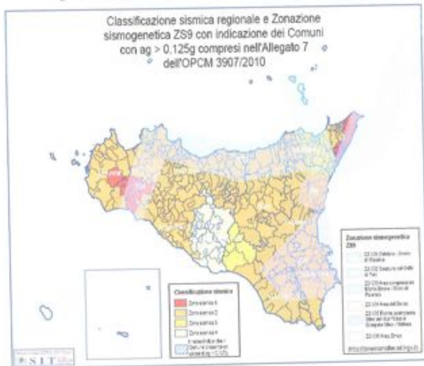
Figura 8: Classificazione Sismica Regionale (DGR n. 408 del 19/12/2003) con indicati sovrapposti a mezzo retino i Comuni con a_g > 0,125g di cui all'Allegato 7 dell'OPCM 3907/2010 e le Zone sismogenetiche ZS9.
