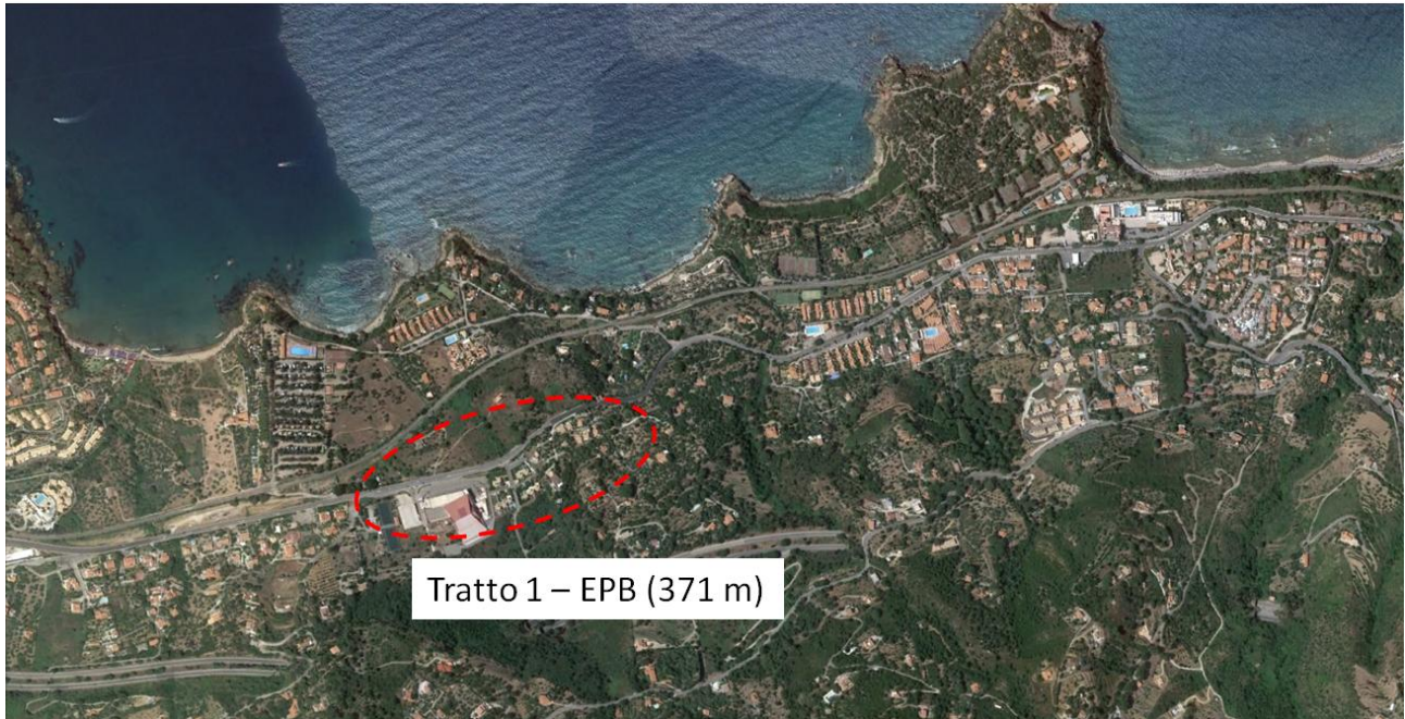
Figura 2. Tratto 1 da scavare con metodologia EPB della lunghezza complessiva di 371 m
