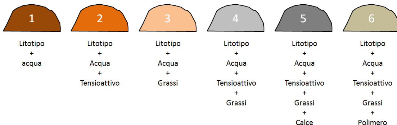
Figura 19. Schema della configurazione iniziale con il quale ciascuno dei sei cumuli da 8 kg è stato condizionato.
