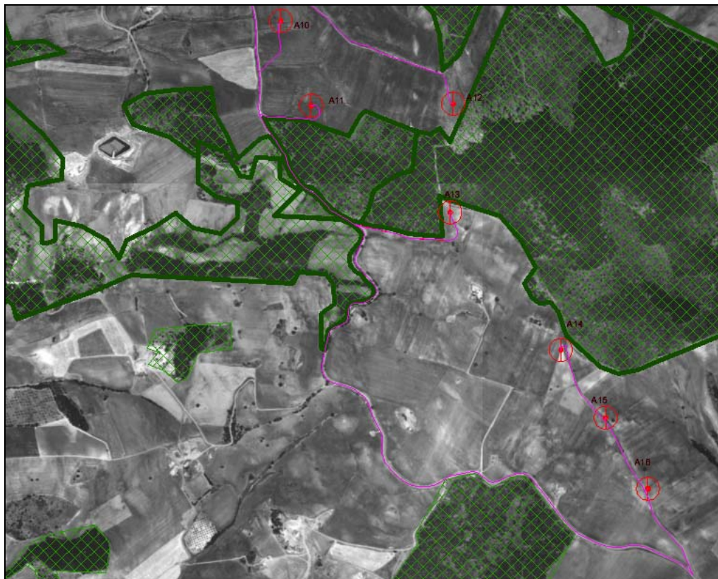
Figura 35: Particolare dell' attraversamento su strada del cavidotto , in prossimità delle aree boscate. Come si nota è completamente su strada.
