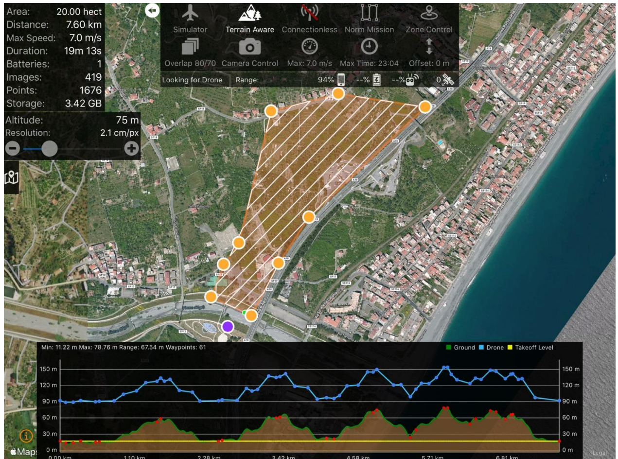
Figura 3 - Pianificazione della missione di volo automatizzato, lato monte rispetto all'A18, legato al profilo derivato dal DSM. In tal modo il programma di comando e controllo crea una rotta lasciando che l'APR viaggi sempre alla stessa quota rispetto al terreno sottostante.
