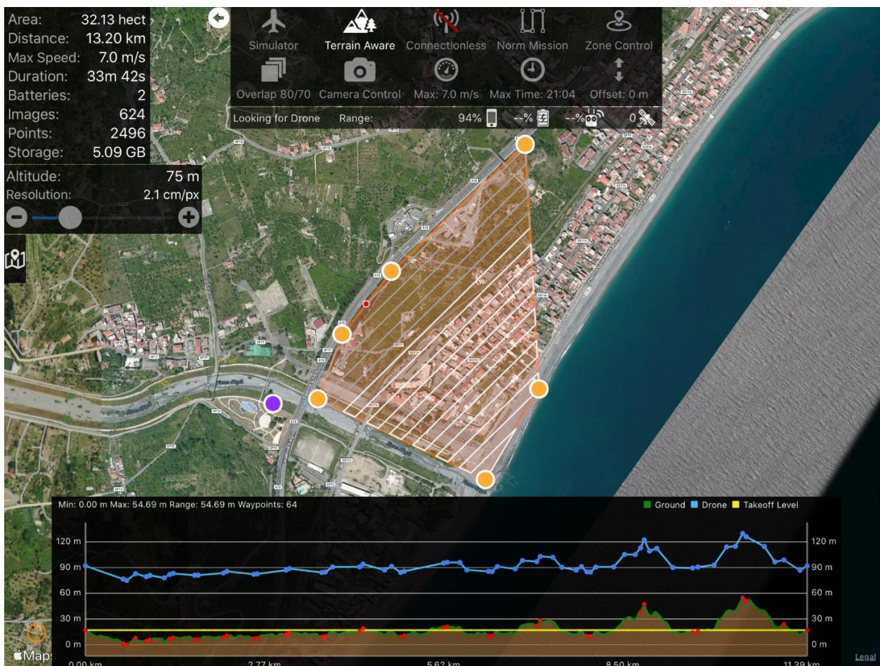
Figura 4 - Pianificazione della missione di volo automatizzato, lato valle rispetto all'A18, legato al profilo derivato dal DSM. In tal modo il programma di comando e controllo crea una rotta lasciando che l'APR viaggi sempre alla stessa quota rispetto al terreno sottostante.
