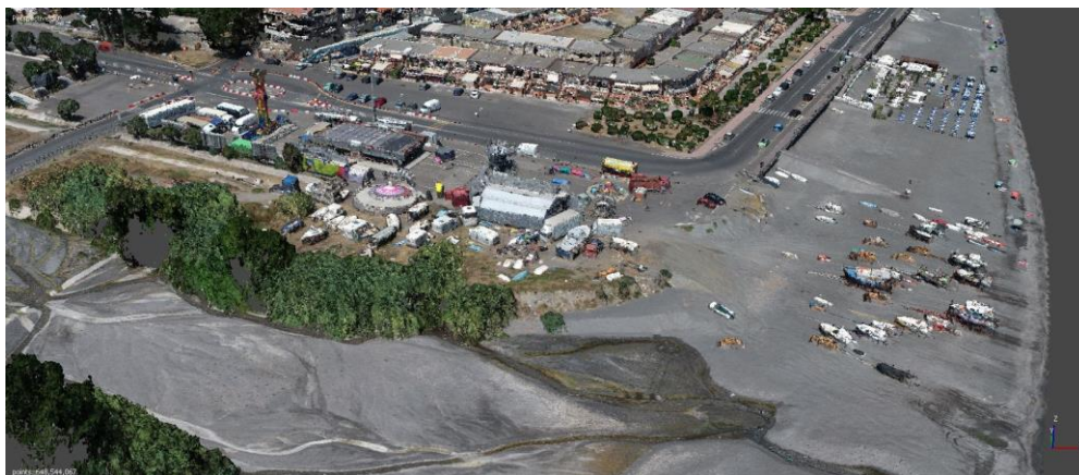
Figura 18 - Nuvola di punti densa e colorata.
