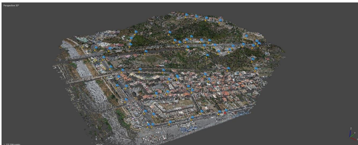
Figura 17 - Proiezione dei GCP (rappresentati dalle bandierine blu) nella nuvola di punti sparsa (punti di giunzione) dopo il riallineamento.
