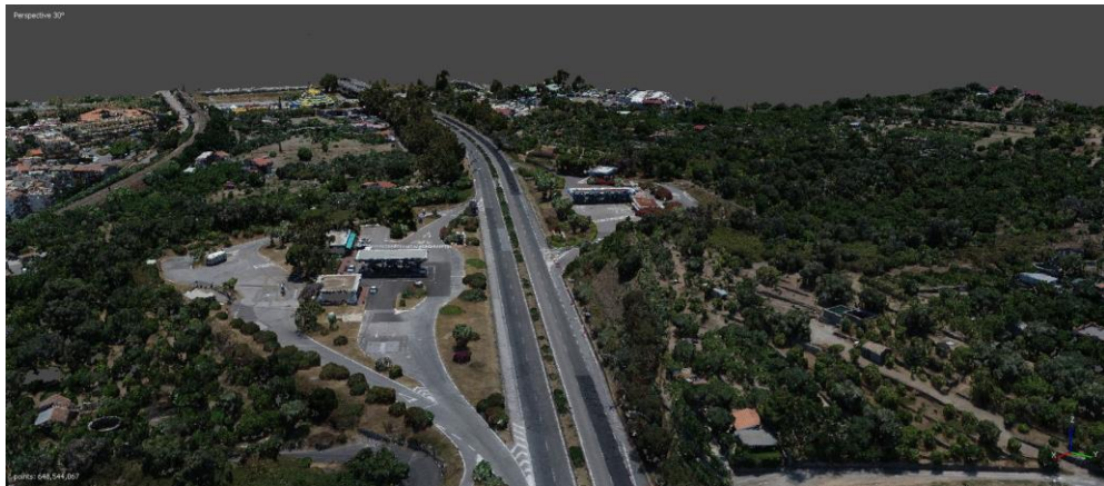
Figura 20- Nuvola di punti densa e colorata.
