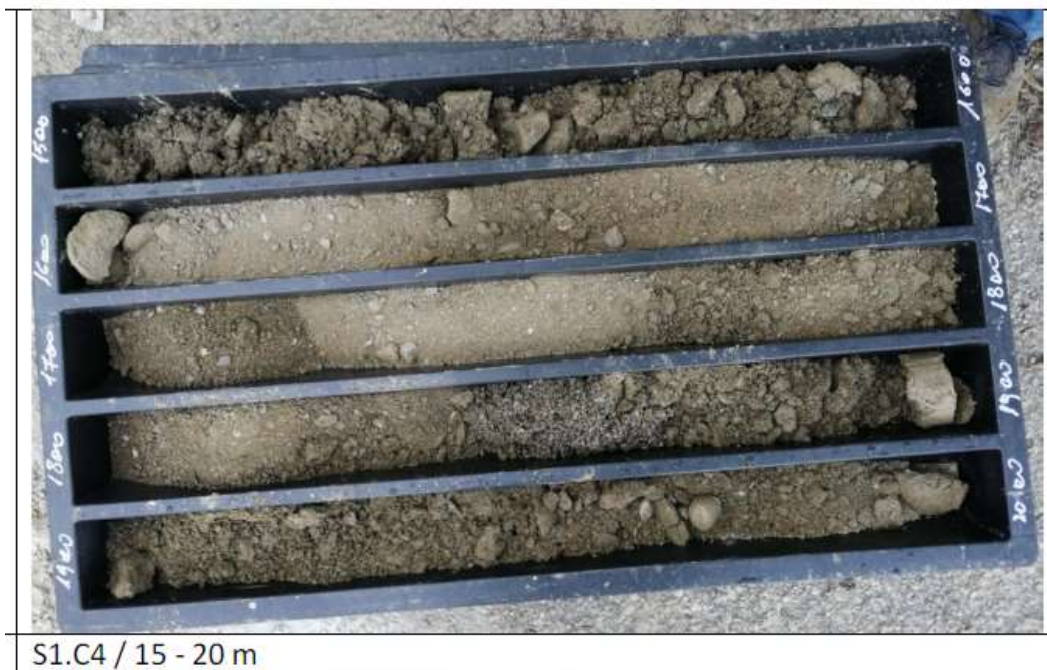
Figura 15 – Documentazione fotografica cassetta catalogatrice - SN1 (da 15 a 20 m)
