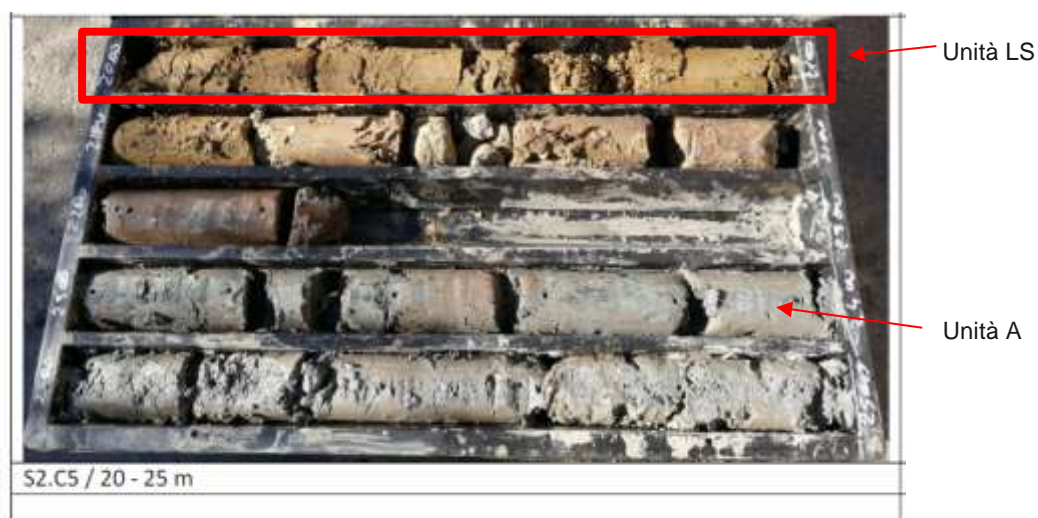
Figura 16 – Documentazione fotografica cassette catalogatrici sondaggio SN2 (unità S fino a 21.5 m)
