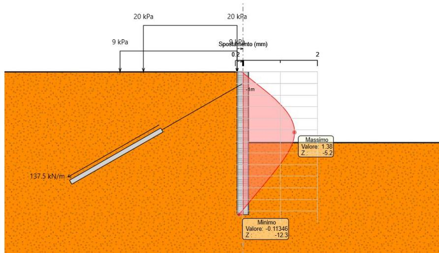
Figura 25 Involuppo spostamenti allo SLE.  $|\mu_{max}|=1.38$  mm
