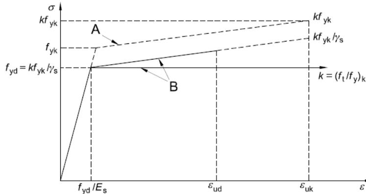
**Figura 7 Legame costitutivo di progetto per l'acciaio**
