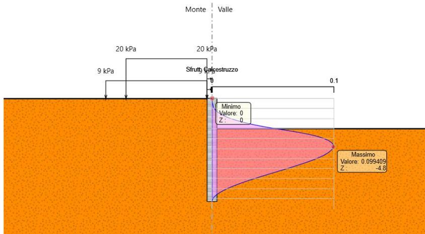
**Figura 13** Verifica tensioni di esercizio nel calcestruzzo
