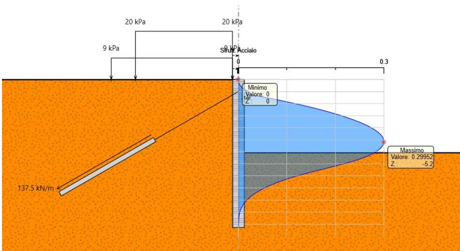
**Figura 30** Verifica tensioni di esercizio nell'acciaio
