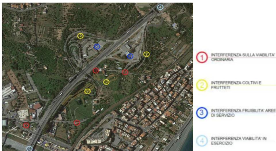
Figura 4-19 Schematizzazione delle interferenze delle aree di cantiere sul contesto di riferimento
