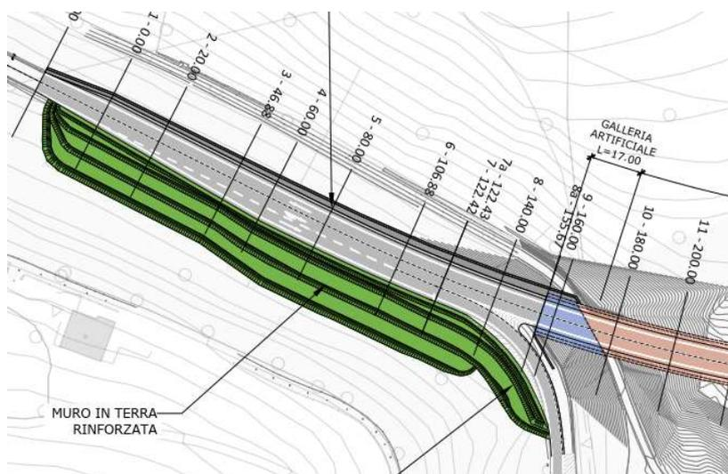
**Figura 3 – Planimetria di progetto – Imbocco Ovest**
