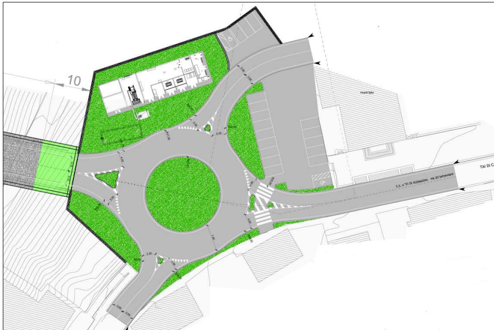
Figura 2 – Planimetria progetto stradale lato est - PD
