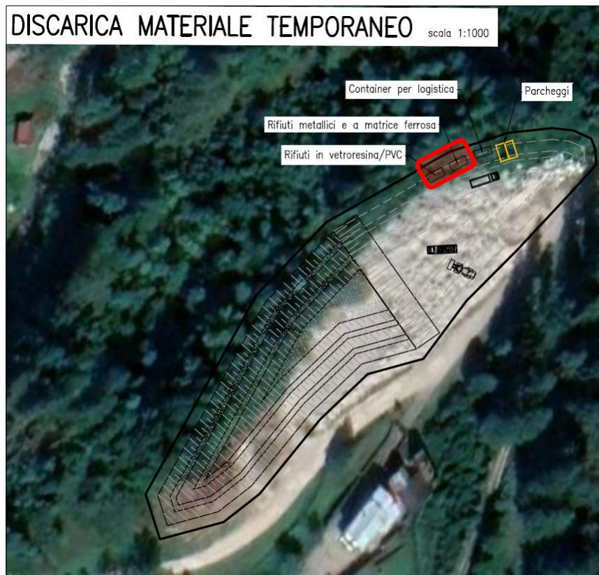
Figura 56 – Sito di deposito temporaneo area ex vivaio forestale: area raccolta differenziata.
