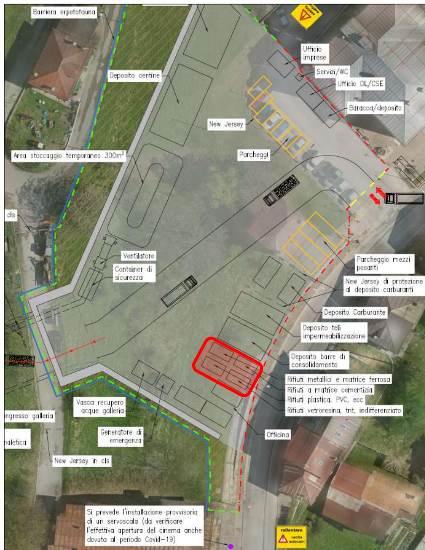
Figura 55 – Cantiere 1: area raccolta differenziata.
