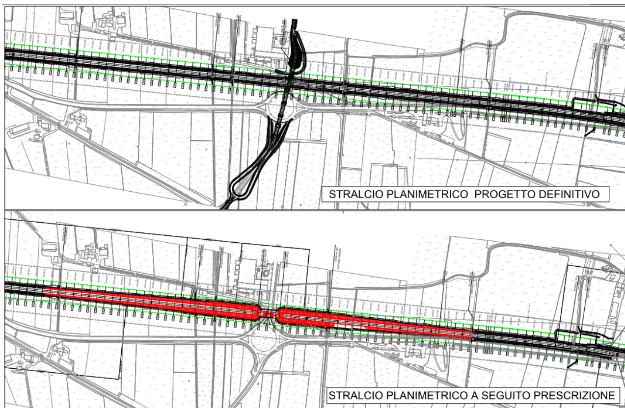
Figura 4 – Variante PR.29 - Eliminazione cavalcaferrovia IV06 (intersezione con rotatoria del Grena) e innalzamento livelletta
