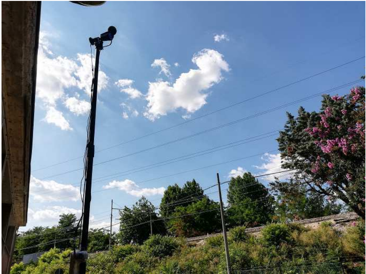
Figura 33 Posizionamento della telecamera e fonometro in adiacenza alla ferrovia
