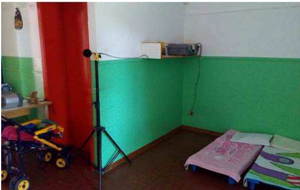
Figura 38 Posizionamento della strumentazione all'interno del ricettore
