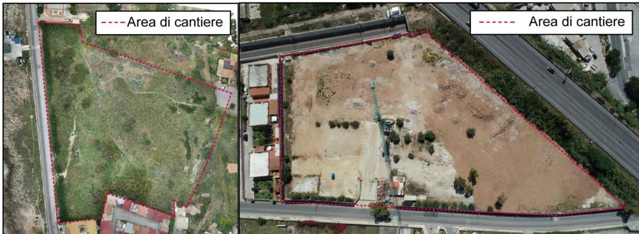
**Figura 27 – Raffronto area di cantiere per prefabbricazione massi progetto definitivo (SX) ed esecutivo (DX)**
