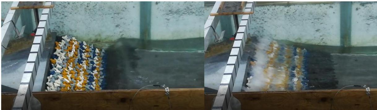
Figura 3 – Prove su modello fisico della sezione tipo della diga foranea eseguite dall'università di Catania
