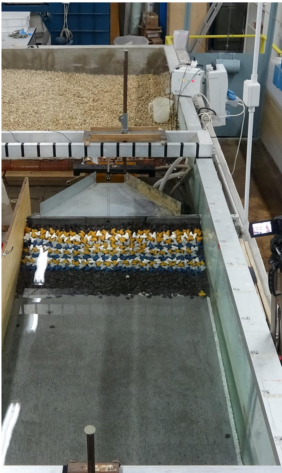
Figura A. 21 Configurazione del modello dopo la simulazione dell'onda 2 dello stato di mare III.
