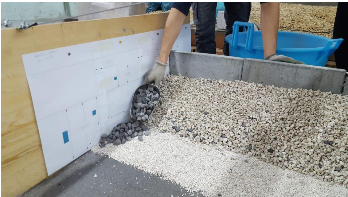
Figura 4.24 Posa in opera del materiale basaltico (diametro teorico compreso tra 16.1-18.1 mm) per la realizzazione della berma.
