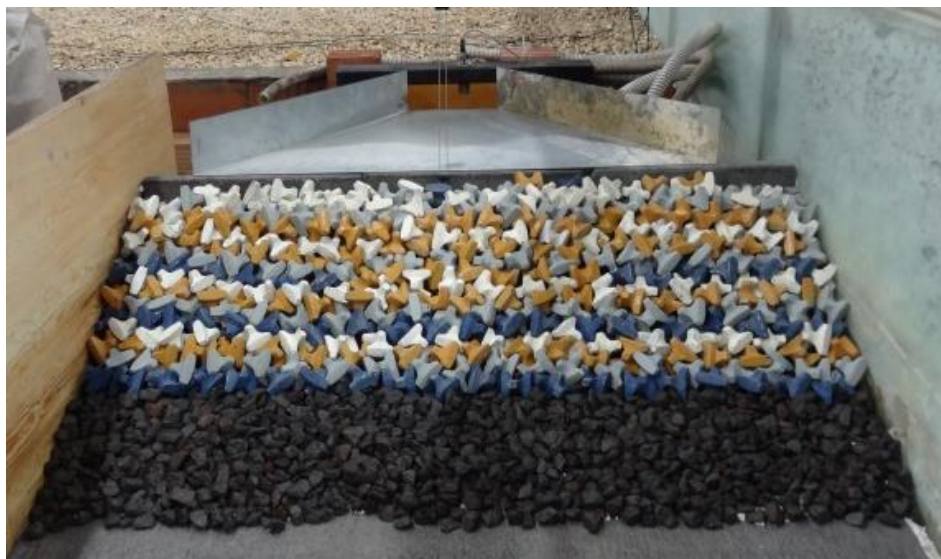
Figura 4.28 Configurazione 2: posa in opera degli Accropodi da 16 m 3 a scala di prototipo.
