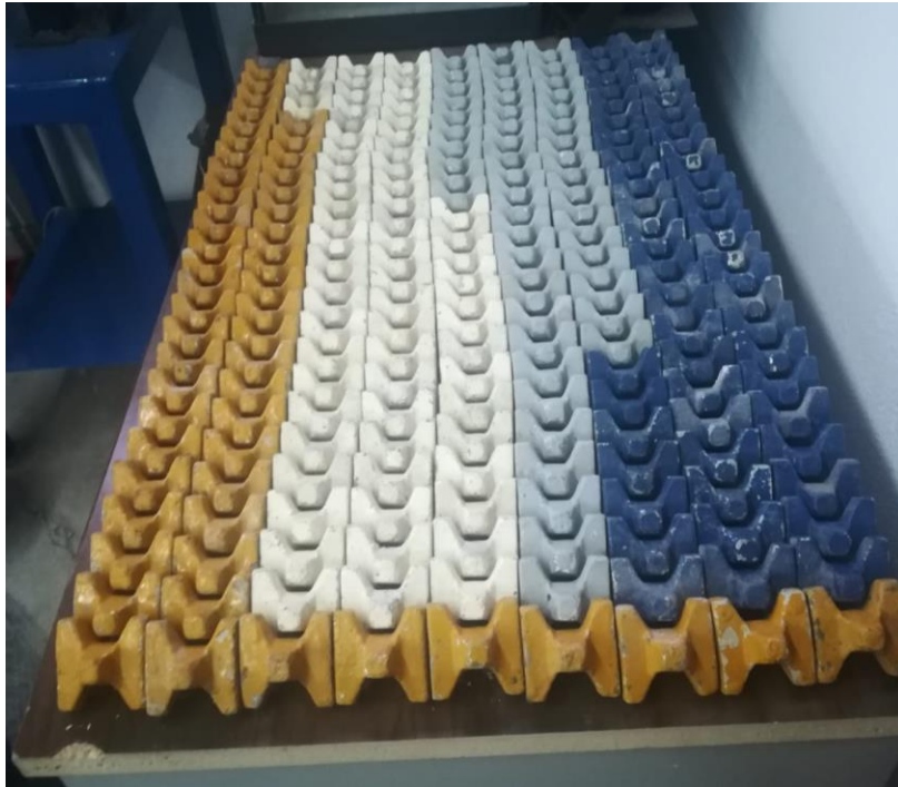
Figura 4.14 Accropodi realizzati mediante colatura di una miscela di resina, polvere di basalto e polvere di ferro.
