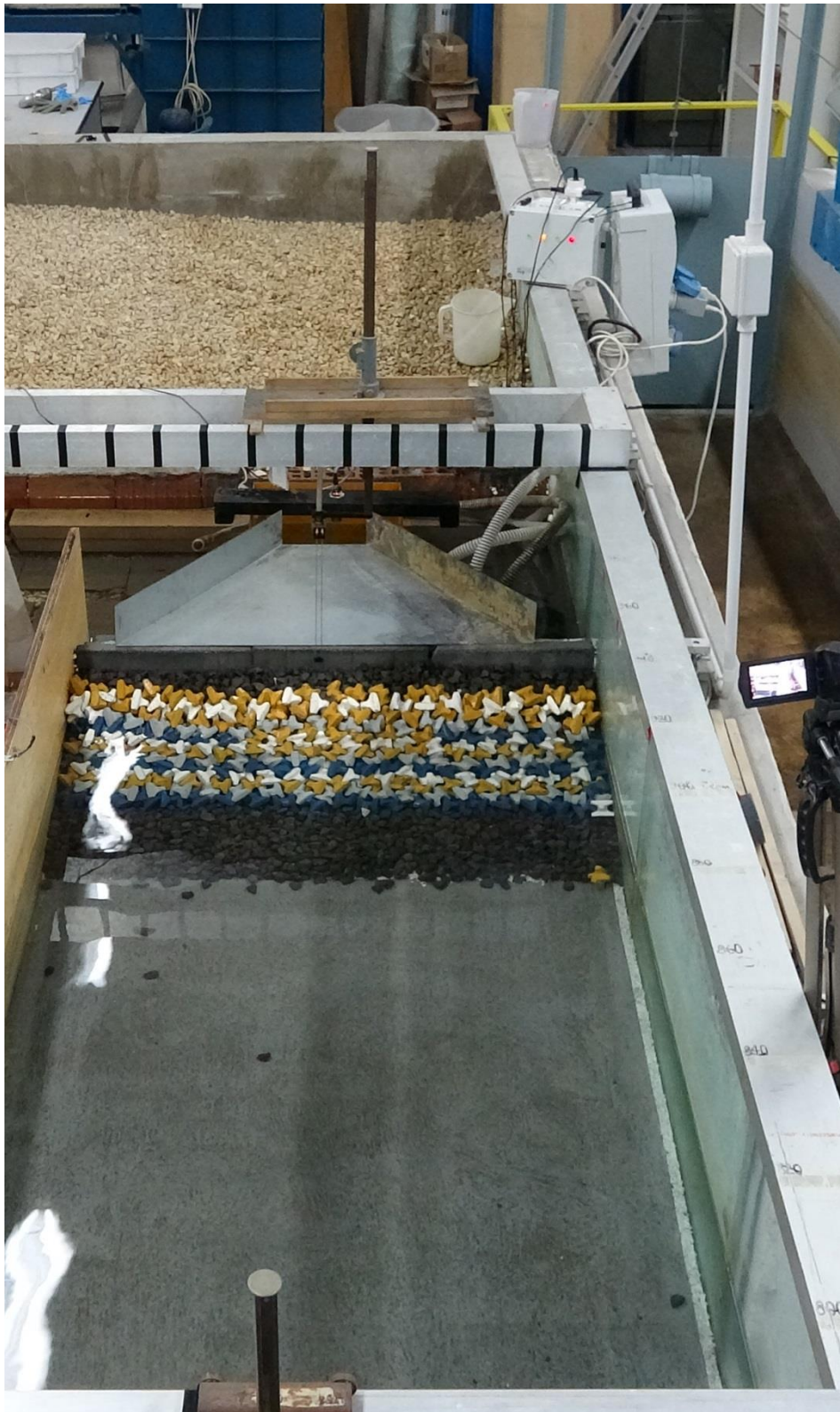
Figura A. 22 Configurazione del modello dopo la simulazione dell'onda 3 dello stato di mare III.
