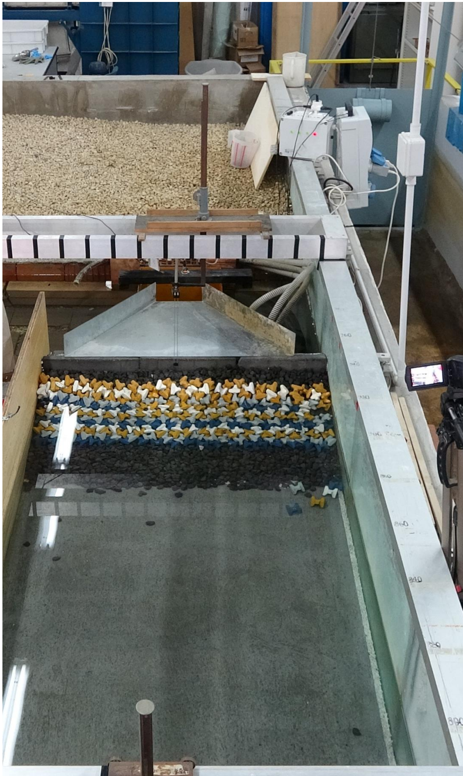
Figura A. 25 Configurazione del modello dopo la simulazione dell'onda 2 dello stato di mare III.
