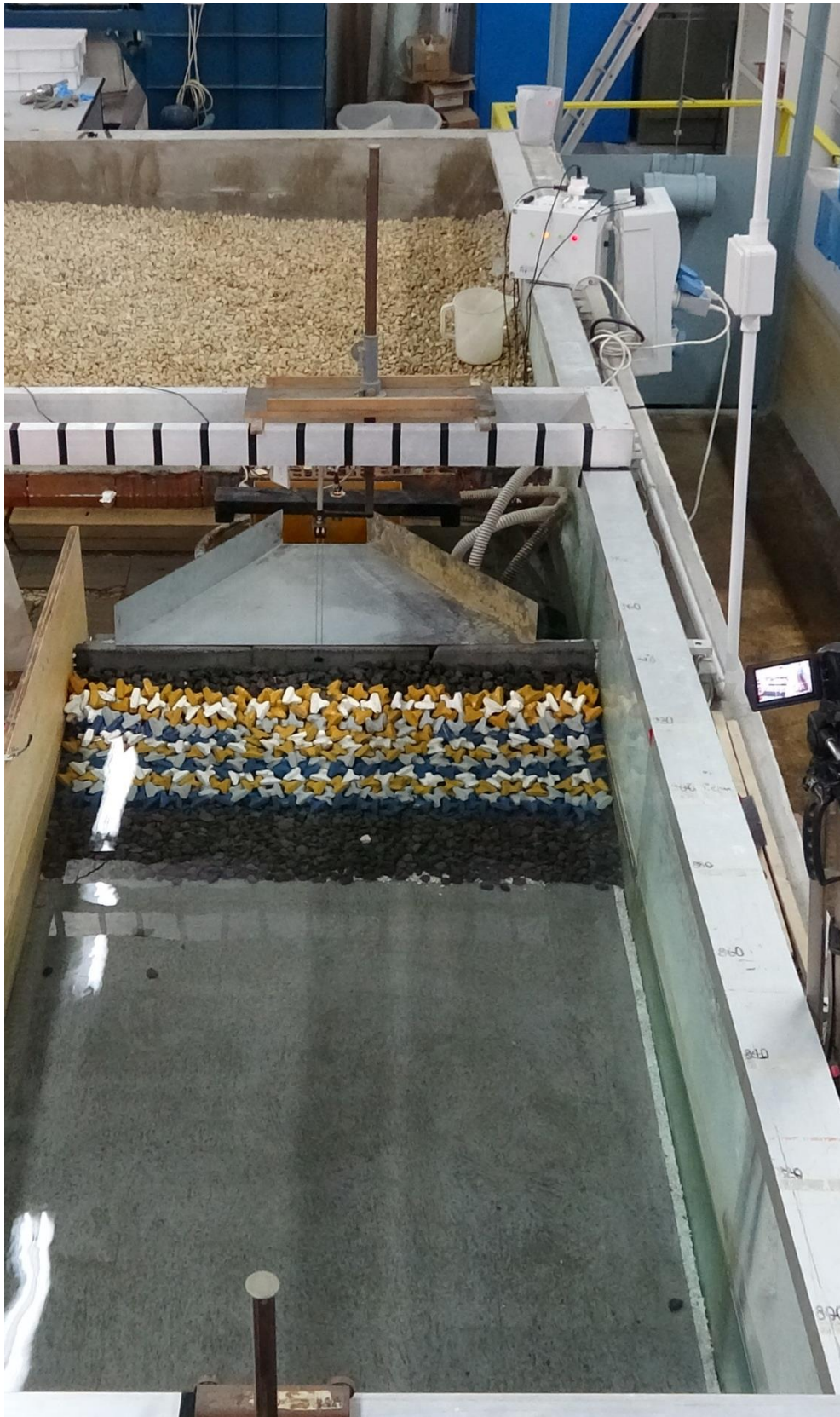
Figura A. 16 Configurazione del modello dopo la simulazione dell'onda 3 dello stato di mare I.
