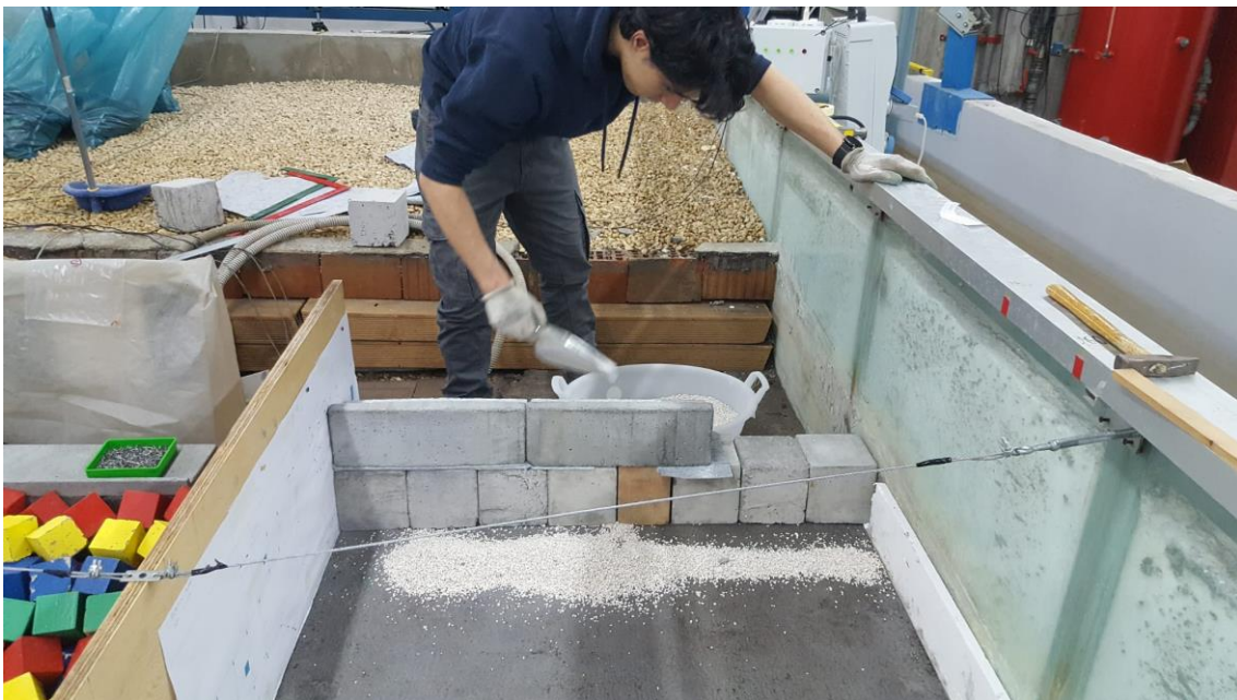
Figura 4.20 Posa in opera di granulato di marmo per la riproduzione dall'andamento plano-altimetrico del terreno al disotto della diga.
