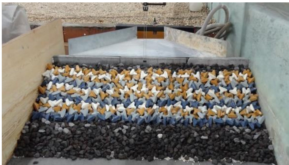
Figura 4.27 Configurazione 1: posa in opera degli Accropodi da 16 m 3 a scala di prototipo.
