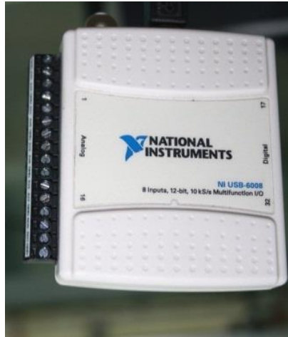
Figura 4.8 Scheda d'acquisizione National Instrument (NIUSB 6008).
