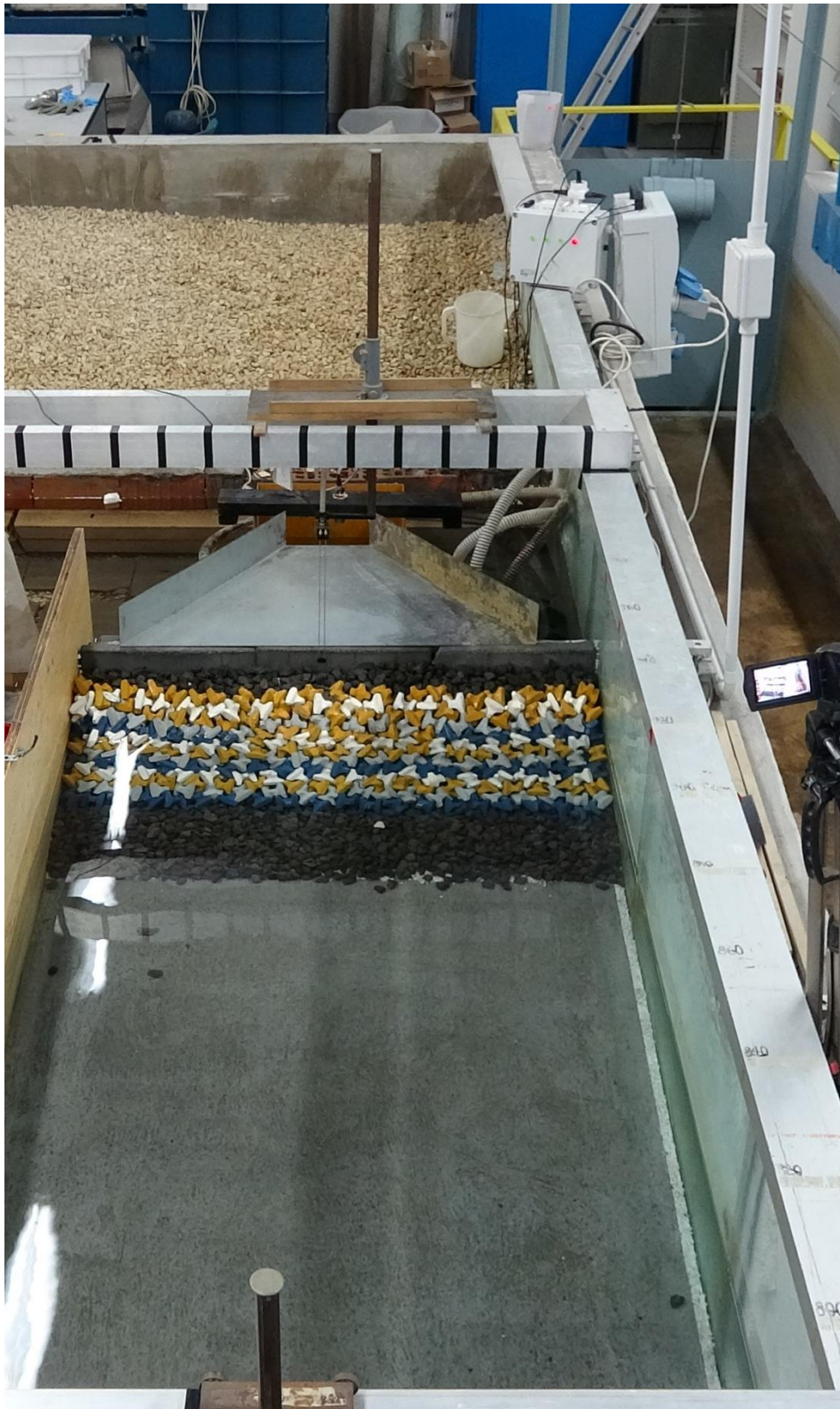
Figura A. 18 Configurazione del modello dopo la simulazione dell'onda 2 dello stato di mare II.
