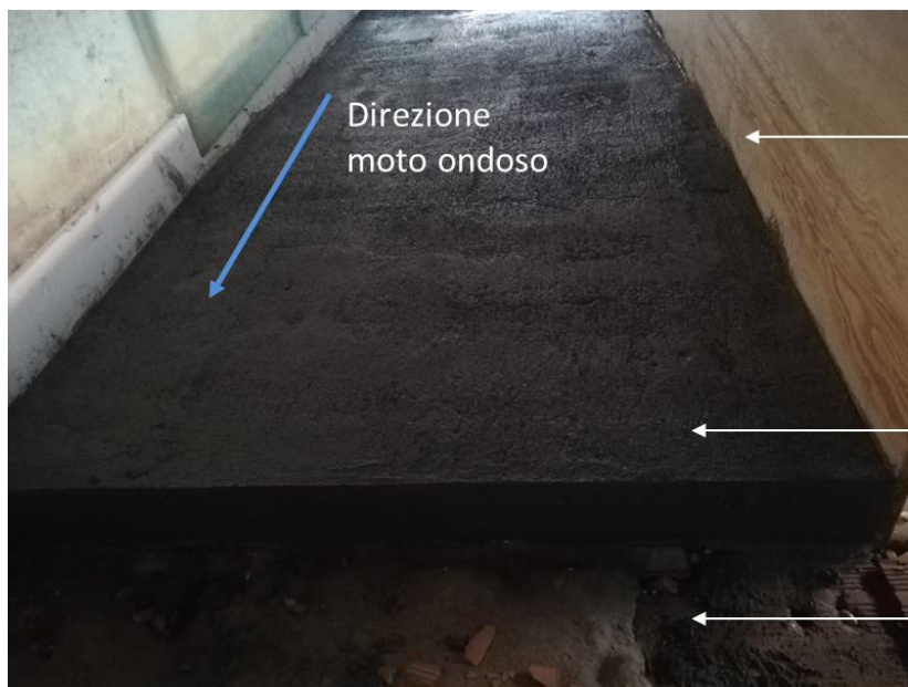
Figura 4.15 Realizzazione della batimetria idealizzata del fondo con una spiaggia piana avente pendenza pari a 6.5%.
