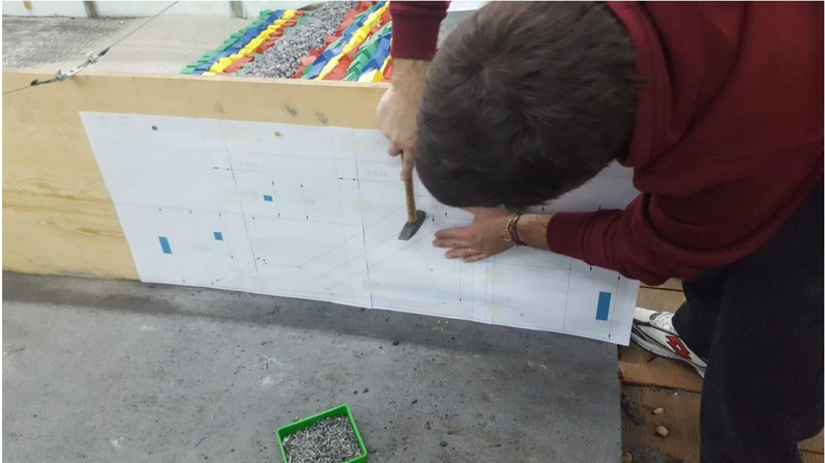
Figura 4.16 Riproduzione della sezione della diga sulle pareti del canale.
