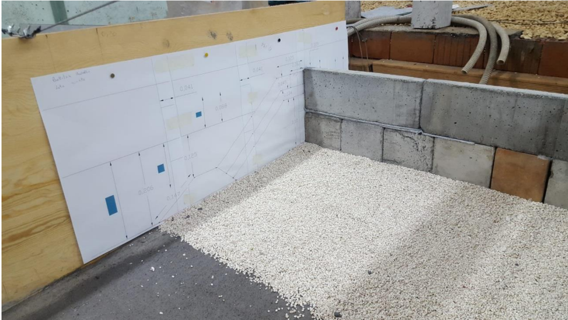
Figura 4.21 Posa in opera di granulato di marmo per la riproduzione dall'andamento plano-altimetrico del terreno al disotto della diga: configurazione finale.
