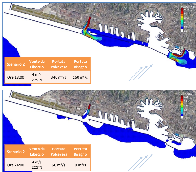
FIGURA 6-3 - STATO ATTUALE - SCENARIO 2: CAMPO DI VELOCITÀ OTTENUTO ALLE ORE 18:00 E ALLE ORE 24:00.
