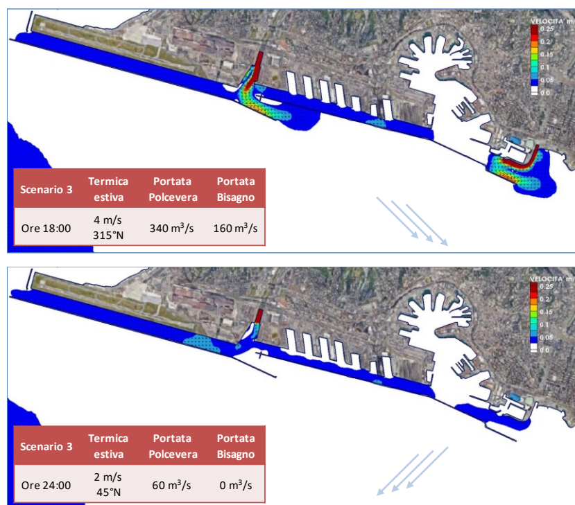
FIGURA 6-4 - STATO ATTUALE - SCENARIO 3: CAMPO DI VELOCITÀ OTTENUTO ALLE ORE 18:00 E ALLE ORE 24:00.
