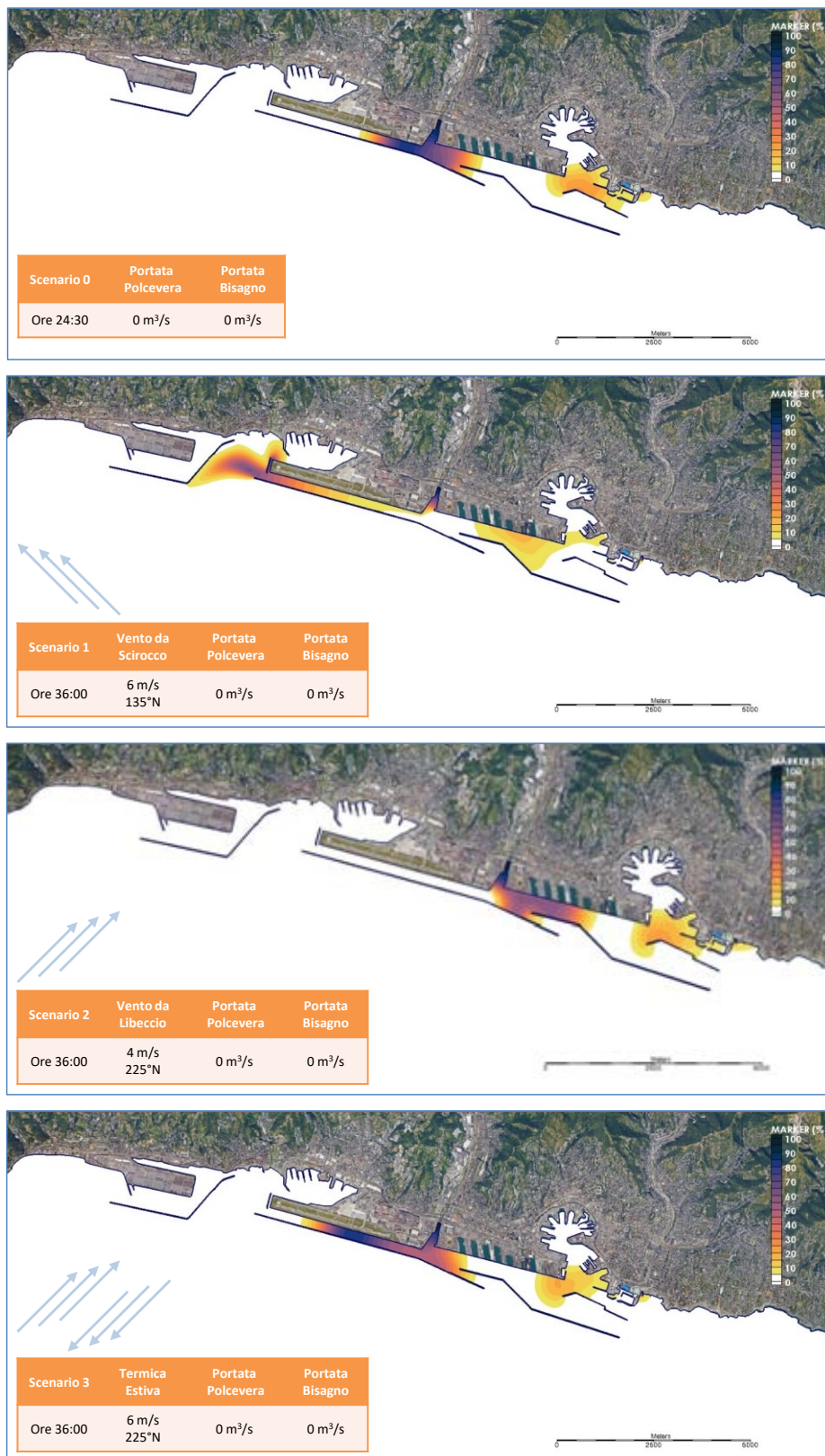
FIGURA 7-4- SOLUZIONE 3 – FASE B - CONCENTRAZIONE DEL MARKER OTTENUTA PER I DIVERSI SCENARI DI SIMULAZIONE A CIRCA 10 ORE DAL TERMINE DEGLI EVENTI DI PIENA DEL POLCEVERA E DEL BISAGNO.
