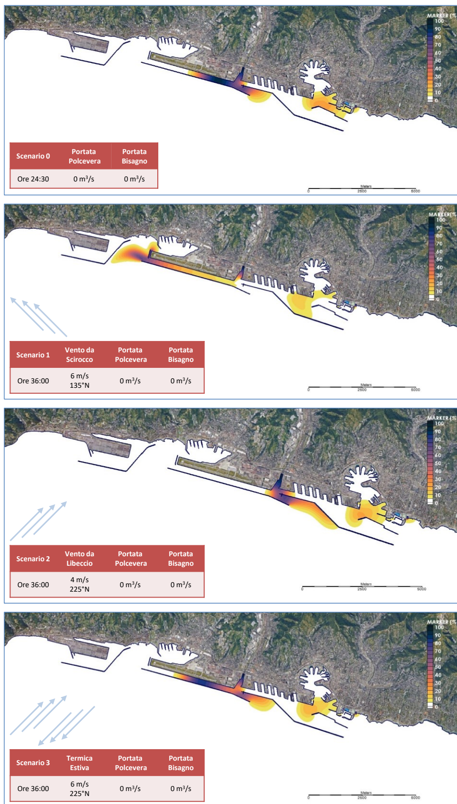
FIGURA 7-3- SOLUZIONE 3 – FASE A -CONCENTRAZIONE DEL MARKER OTTENUTA PER I DIVERSI SCENARI DI SIMULAZIONE A CIRCA 10 ORE DAL TERMINE DEGLI EVENTI DI PIENA DEL POLCEVERA E DEL BISAGNO.
