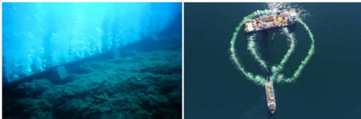
FIGURA 6-1 - ZONE CON CORTINA DI BOLLE RILASCIATA DA UN TUBO PERFORATO POGGIATO SUL FONDO (SINISTRA) E DOPPIA CORTINA DI BOLLE UTILIZZATA INTORNO AD UNA IMBARCAZIONE (A DESTRA) (FONTE: © HYDROTECHNIK LÜBECK GMBH)
