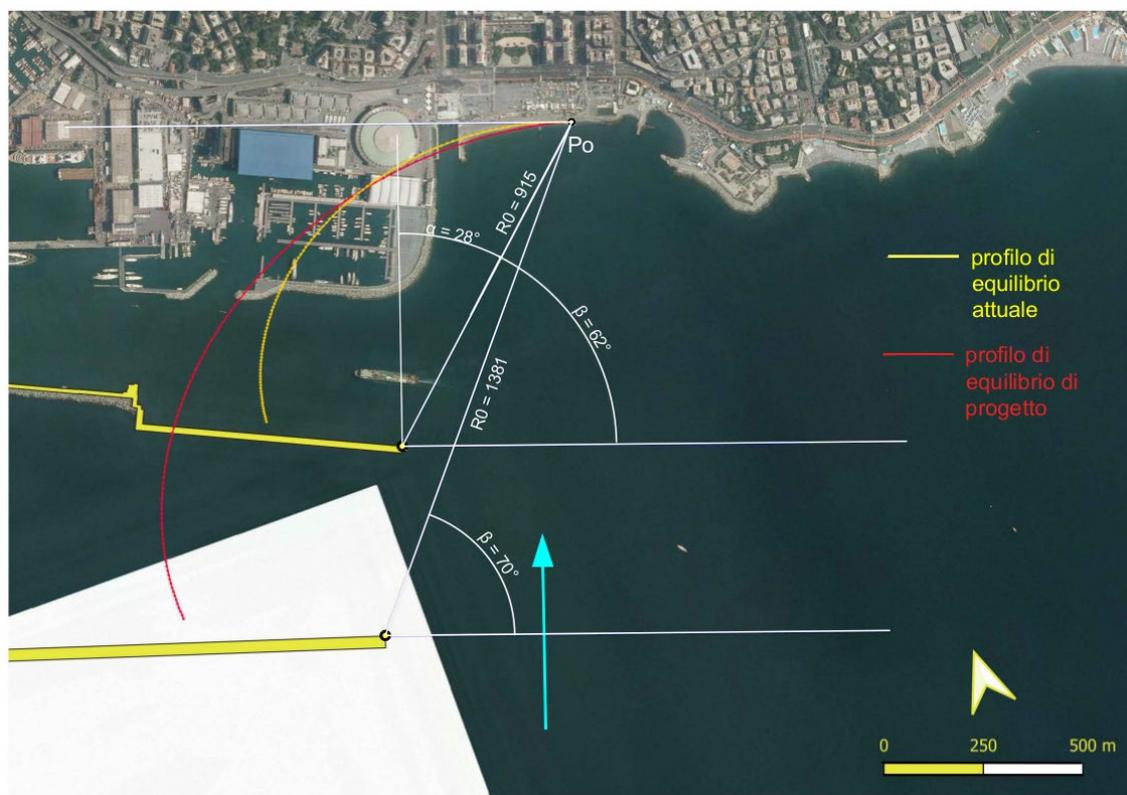
FIGURA 4-41 - TRACCIAMENTO DELLA CURVA PARAMETRICA RAPPRESENTATIVA DEL PROFILO DI EQUILIBRIO DI SILVESTER E HSU PER LO STATO ATTUALE E PER LA CONFIGURAZIONE DI PROGETTO
