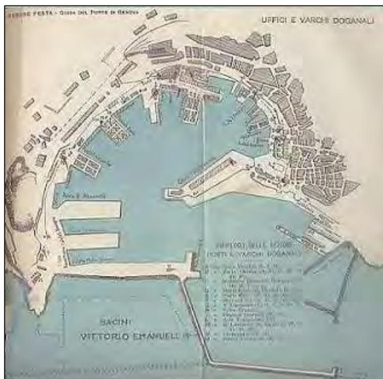
Figura 64. Configurazione del porto e della Diga Galliera nel 1911 con il progetto di costruzione del Bacino Vittorio Emanuele III (Ist. Idrografico M.M.)
