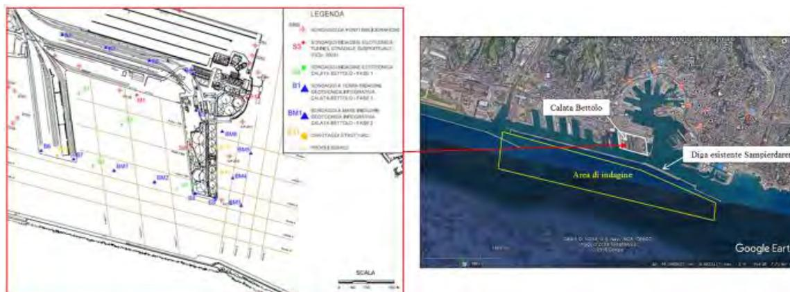
**Figura 7. Ubicazione dell'area di C.ta Bettolo e indicazione dei sondaggi geotecnici.**
