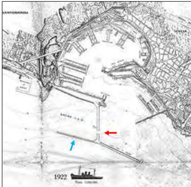
**Figura 53 - Il primo tratto del molo Principe Umberto (freccia azzurra) e il varco aperto nel molo Galliera (freccia rossa) nel 1922 (Archivio CAP)**
