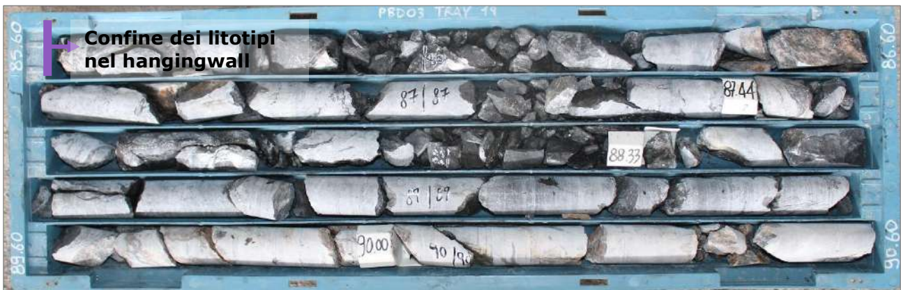
Figura 5.2 Tipiche condizioni della roccia dei litotipi al tetto – Pian Bracca "zona profonda"
