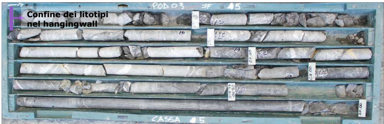
Figura 5.3 Tipiche condizioni della roccia litotipi al tetto – Ponente
