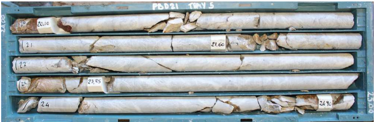
Figura 5.13 Esempio delle condizioni della roccia "tipiche" per l'area mineraria di Ponente
