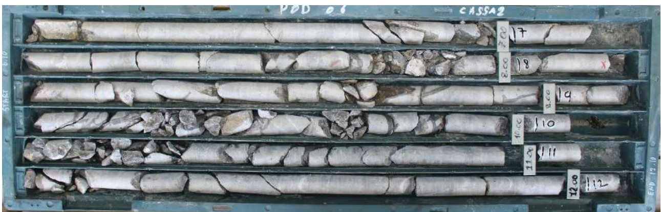
Figura 5.13 Esempio delle condizioni della roccia "tipiche" per l'area mineraria di Ponente
