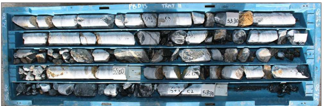
Figura 5.11 Esempio delle condizioni della roccia 'tipiche' per l'area mineraria superficiale di Pian Bracca
