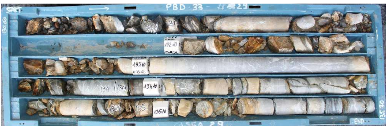
Figura 5.14 Esempio delle condizioni della roccia "tipiche" per il dominio Faglie
