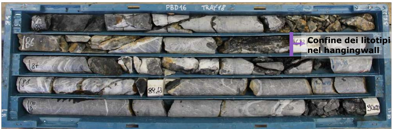
Figura 5.2 Tipiche condizioni della roccia dei litotipi al tetto – Pian Bracca "zona profonda"
