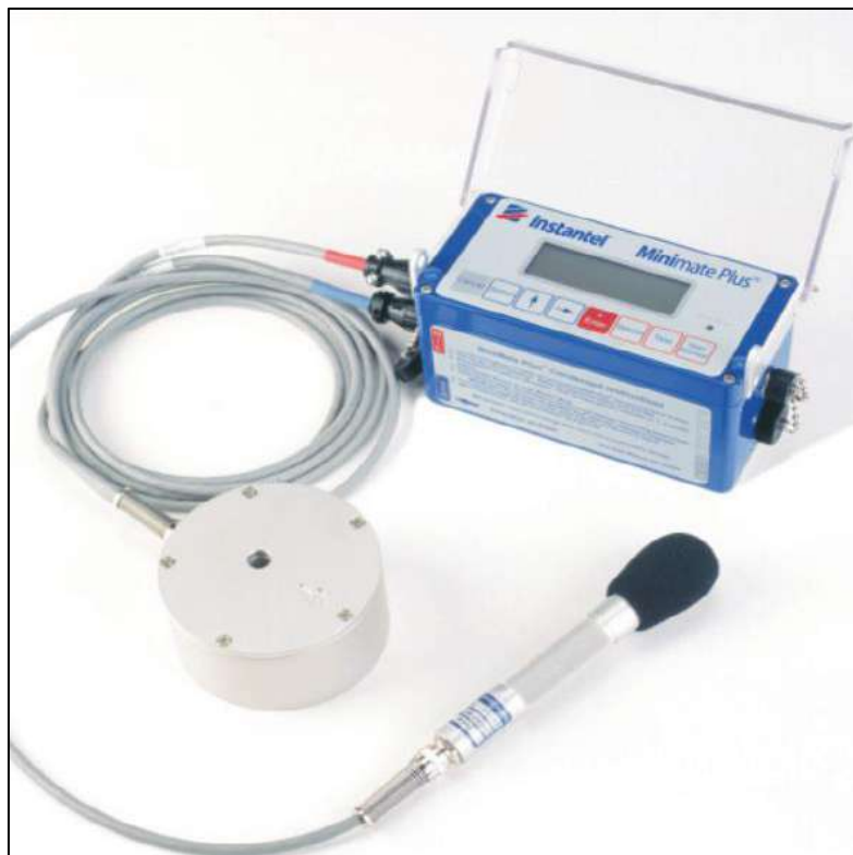
Figura 9.4 Sismografo tipico, geofono e microfono
