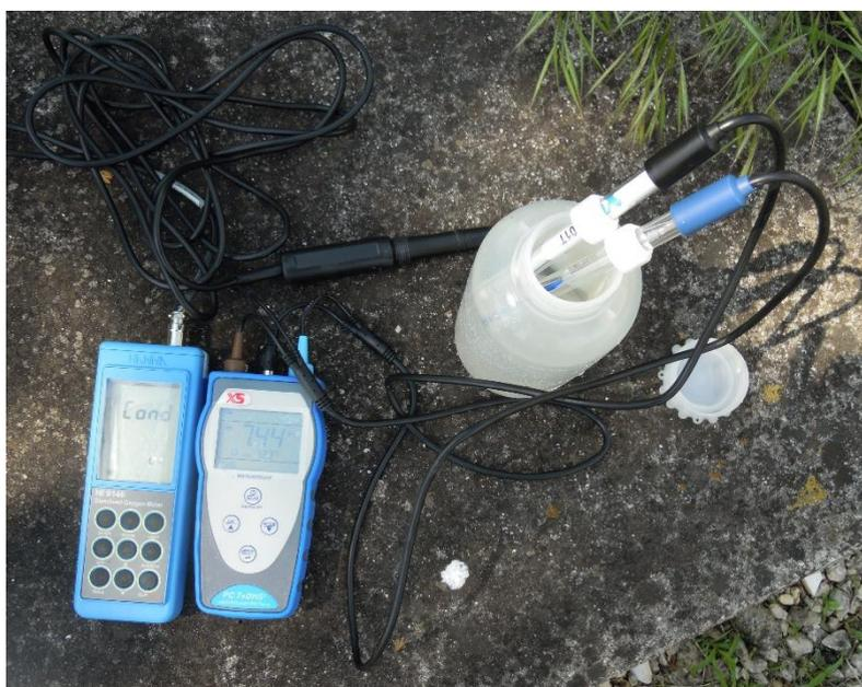
Fig. 14: strumenti portatili per la determinazione di alcuni parametri chimico-fisici a supporto delle analisi biologiche
