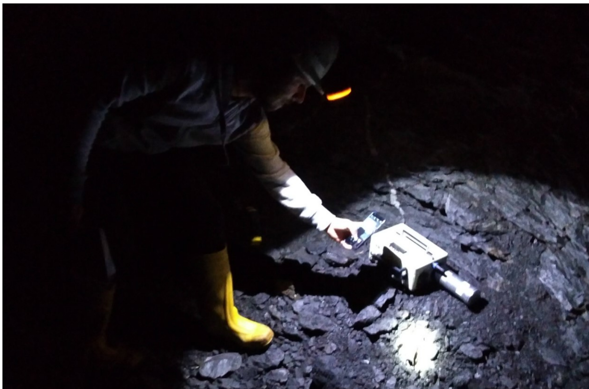
Figura 7- Rilevazioni in galleria mediante radon mapper
