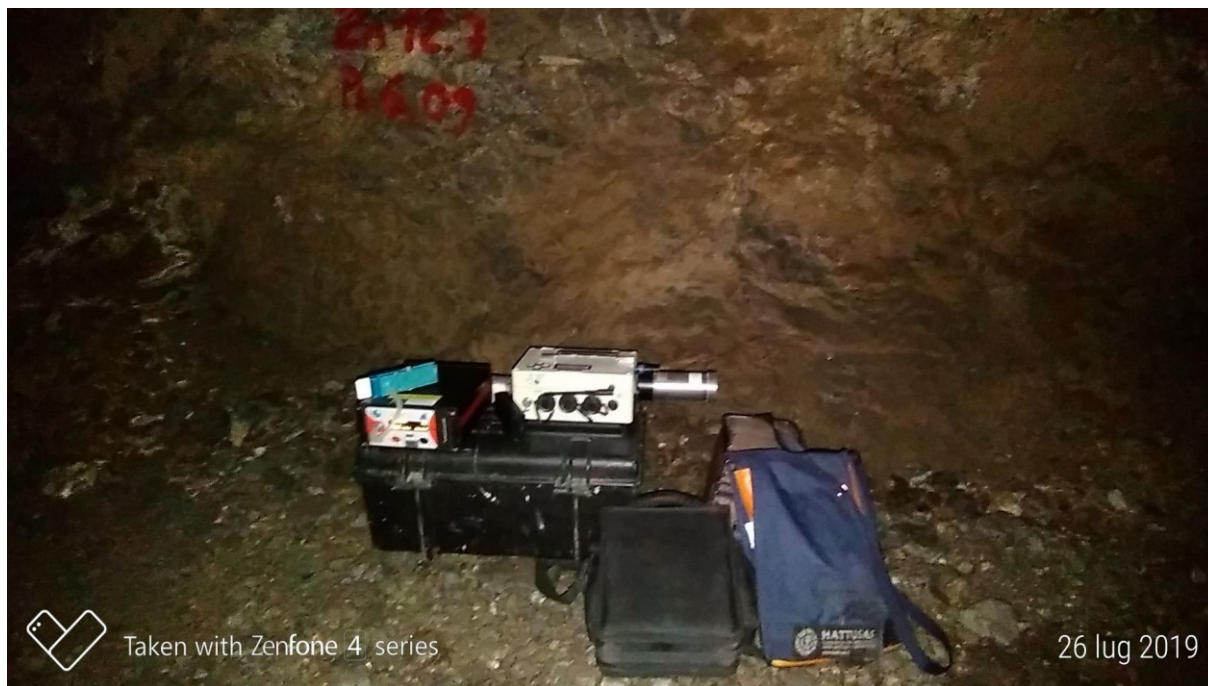
Figura 6-Spettrometro MEAP-V per la misura del potenziale alfa in affiancamento a Radon Mapper per la lettura in continuo di ^{222}\text{Rn} .
