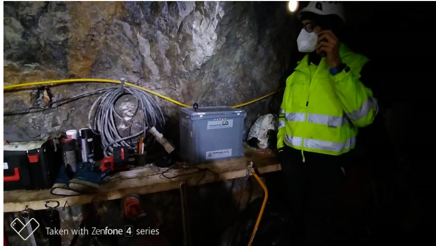
Figura 18_ Predisposizione Radon Mapper per i rilievi in Postazione Foro 33
