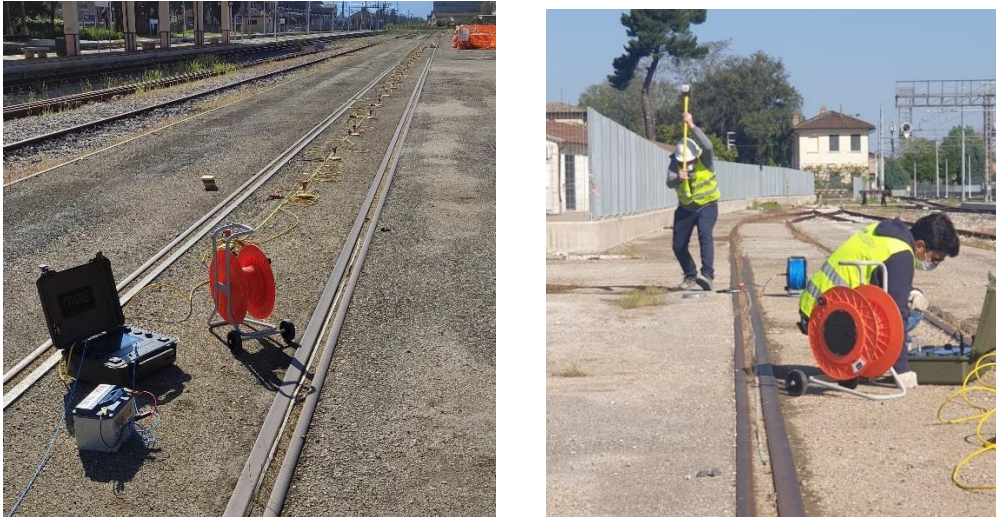
Figura 5 - Esecuzione delle indagini MASW
