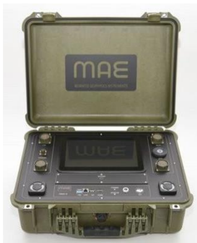
Figura 1 - Sismografo utilizzato per effettuare le indagini sismiche di tipo MASW
