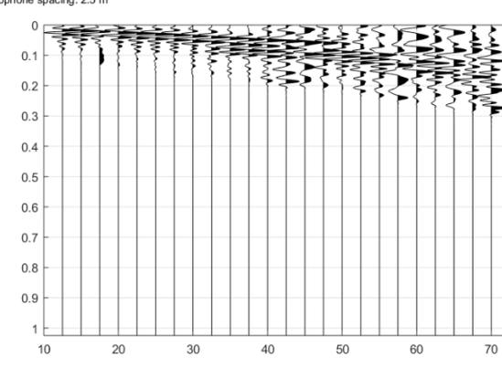
**Figura 6 - Tracce di tutti gli shots effettuati rispettivamente a 7.5, 10 e 12.5 metri, da ogni lato dello stendimento**
