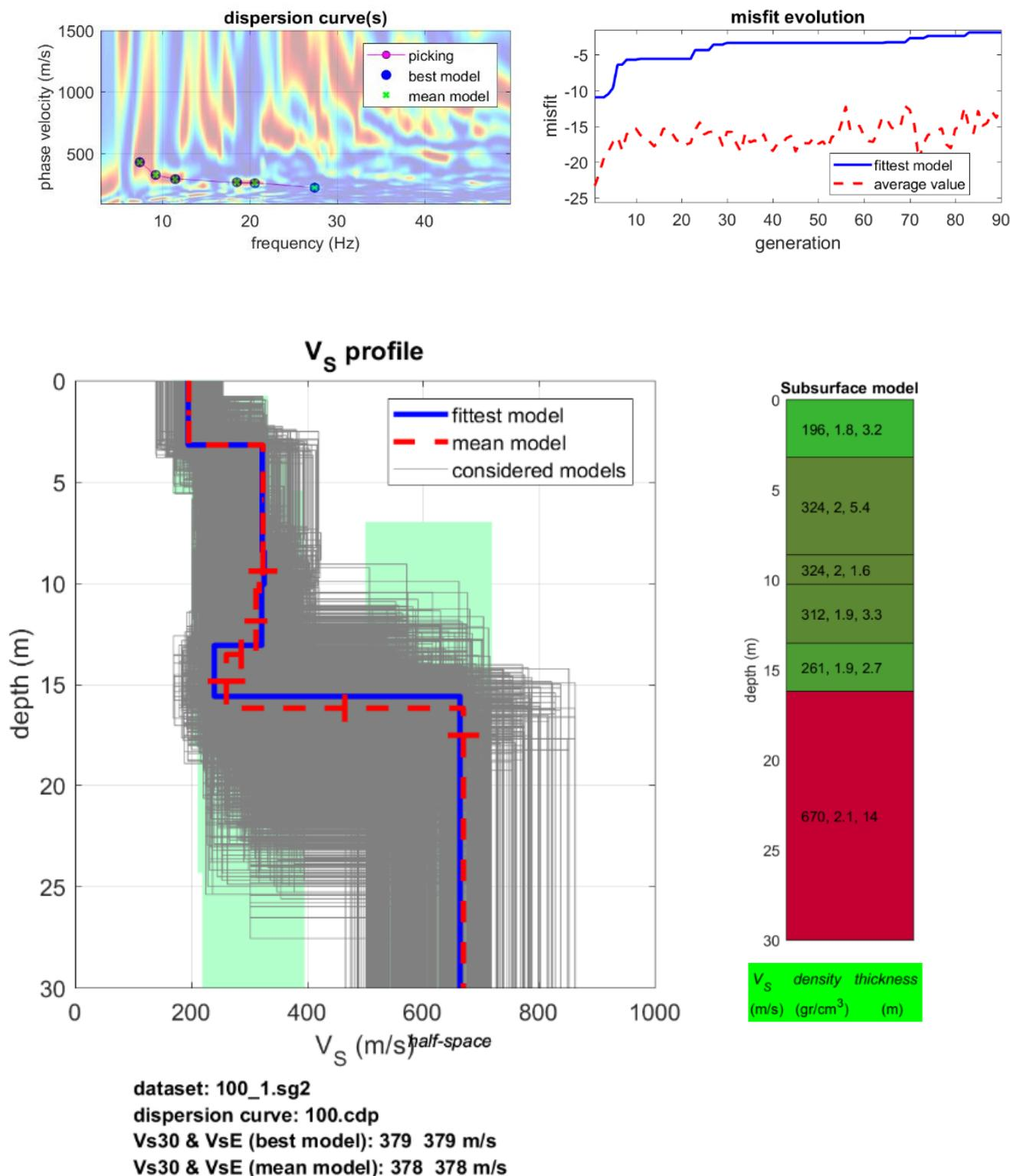
**Figura 14 - Risultati dell'inversione e del modello stratigrafico del sottosuolo**
