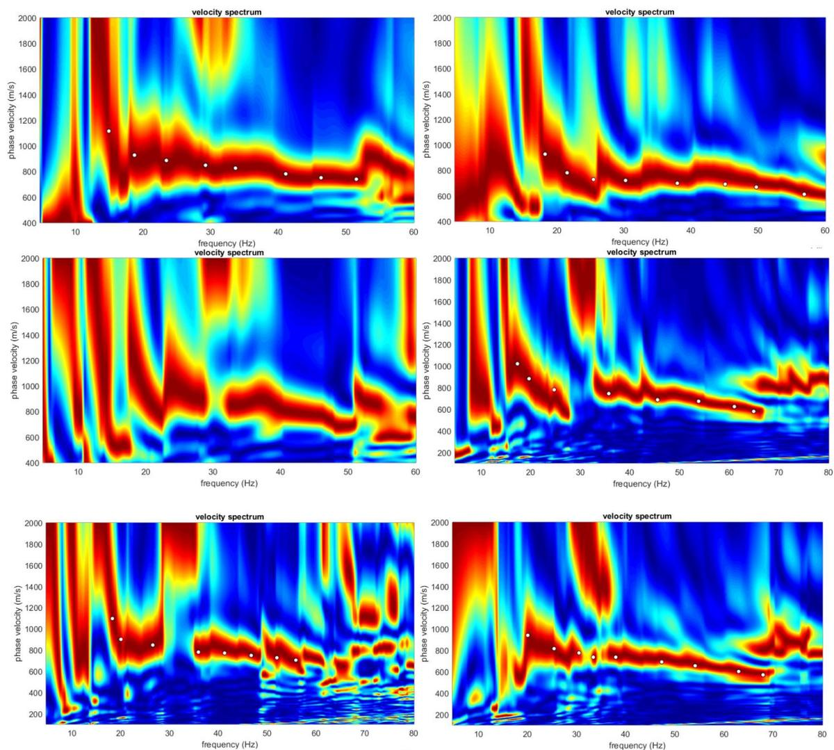
**Figura 7 - Spettri delle tracce di tutti e sei gli shots effettuati.**
