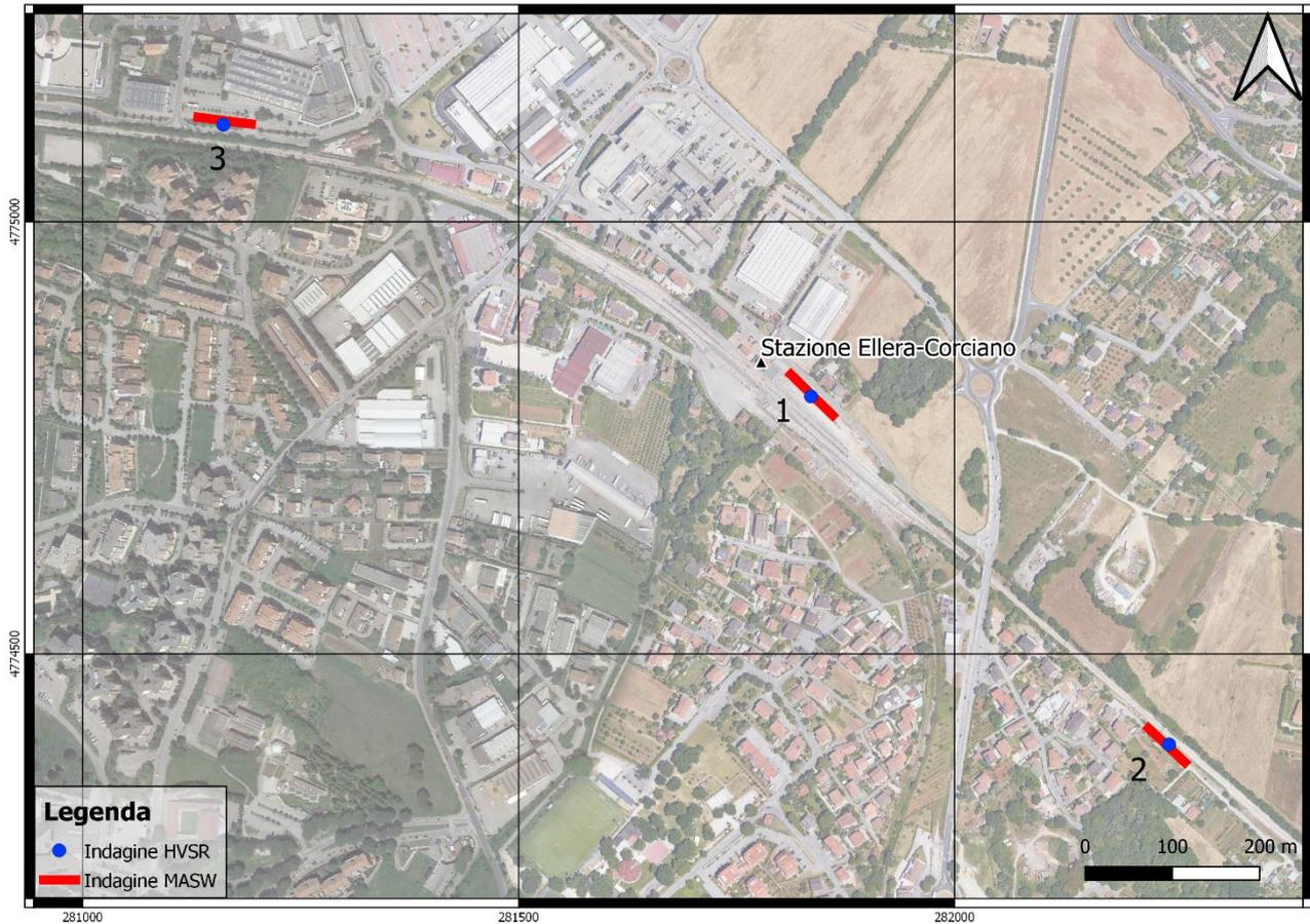
**Figura 3 - Ubicazione delle indagini effettuate presso la stazione di Ellera.**
