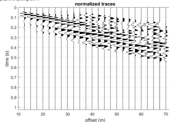
**Figura 19 - Tracce di tutti gli shots effettuati rispettivamente a 7.5, 10 e 12.5 metri, da ogni lato dello stendimento**
