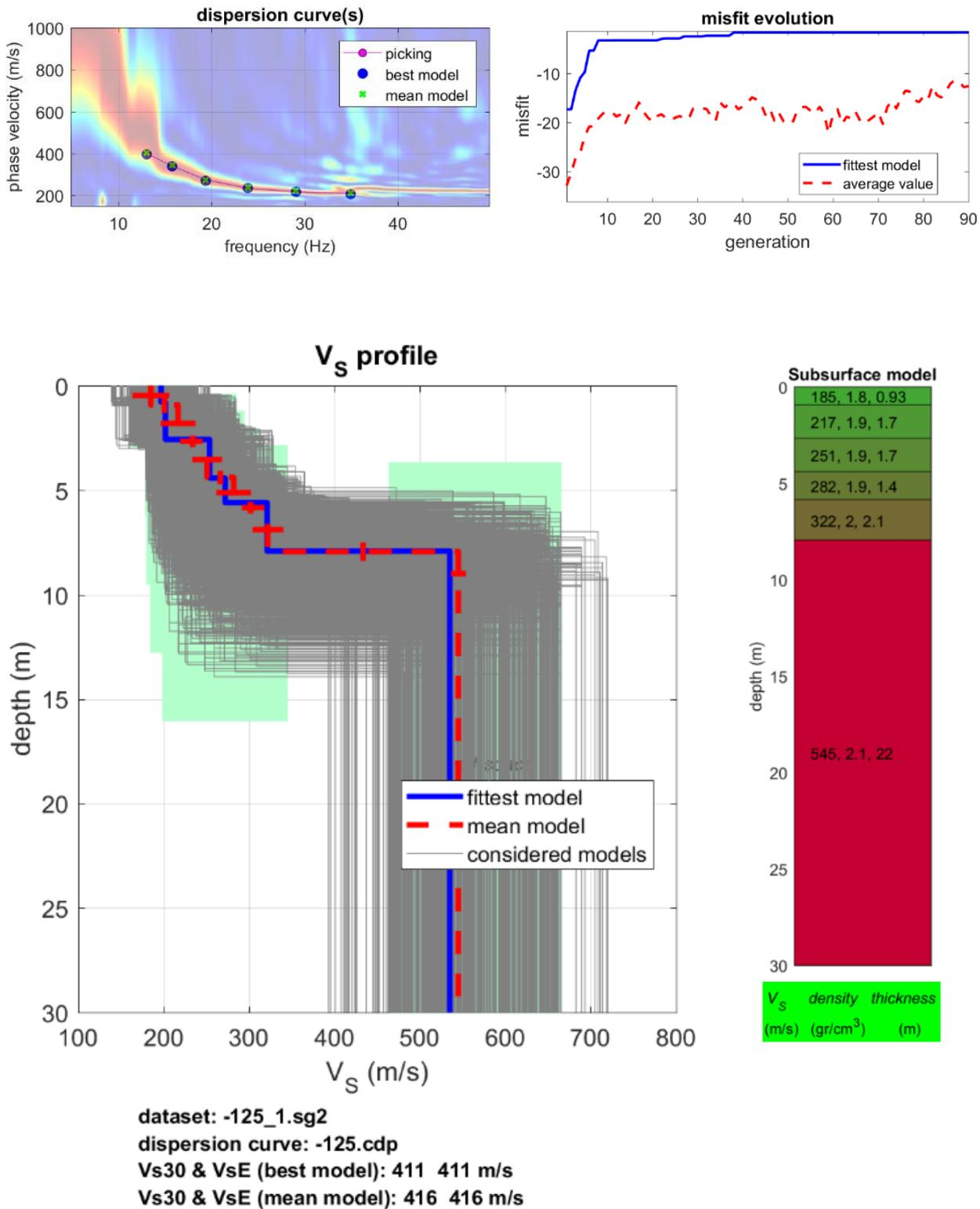
**Figura 8 - Risultati dell'inversione e del modello stratigrafico del sottosuolo**
