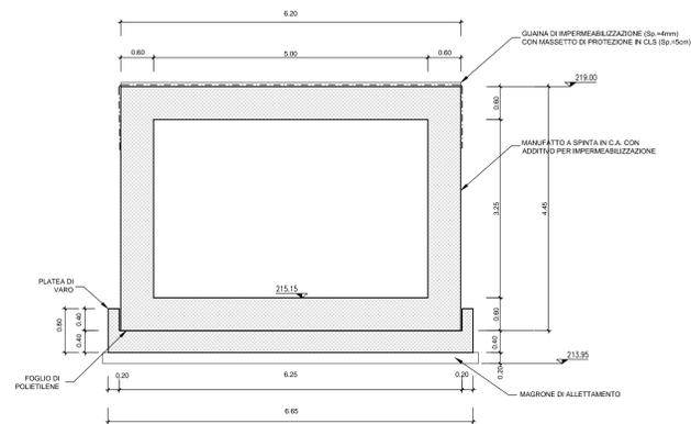
NOTA: per le caratteristiche dei materiali e incidenze di armatura vedasi elaborato: IR0B.01.D.10.TT.OCC0.0.0.001 - "Tabella materiali"
