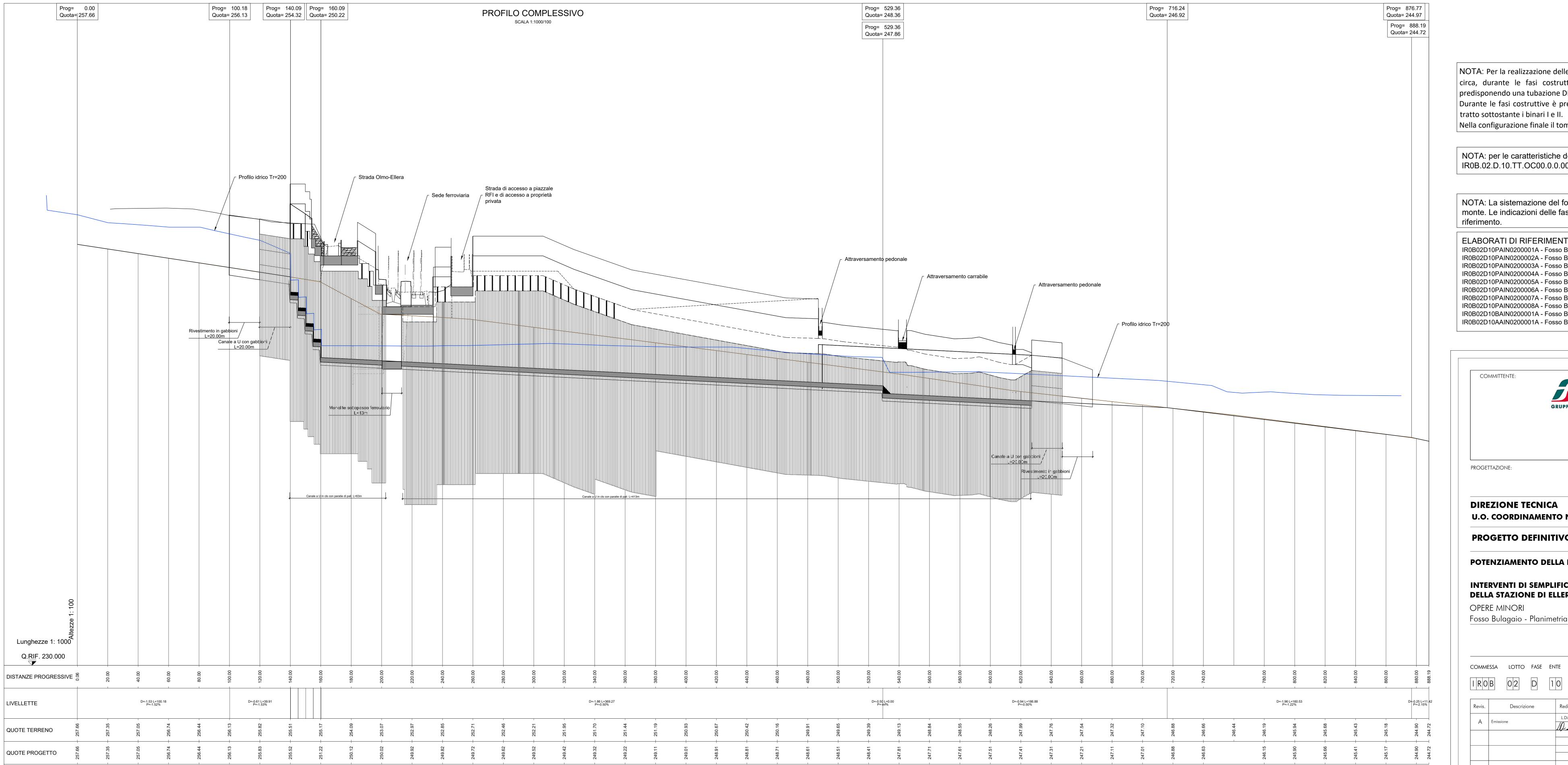
NOTA: Per la realizzazione delle opere comprese tra tra la progressiva 140,00 e 270,00 circa, durante le fasi costruttive è prevista la deviazione provvisoria del fosso, predisponendo una tubazione DN2000 tipo "ARMCO". Durante le fasi costruttive è previsto il funzionamento del tombino esistente nel solo
