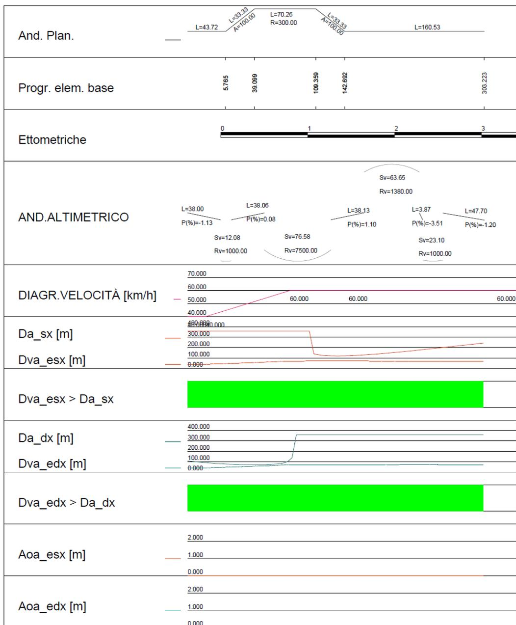
La curva di ampio raggio non determina alcun allargamento delle banchine al fine di garantire una corretta visibilità del tracciato.
