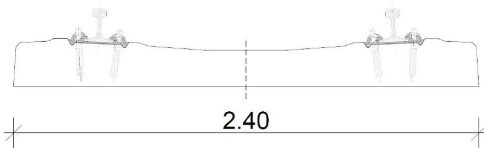
I binari secondari saranno armati con traverse tipo RFI 240 di lunghezza 2,40 m dotate di attacco di tipo elastico conforme alle Specifiche Tecniche RFI con scartamento di 1435 mm.
