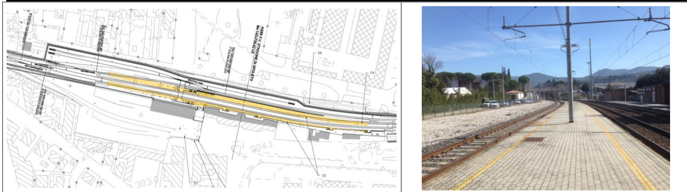
Figura 3-1: Marciapiedi oggetto di demolizione
