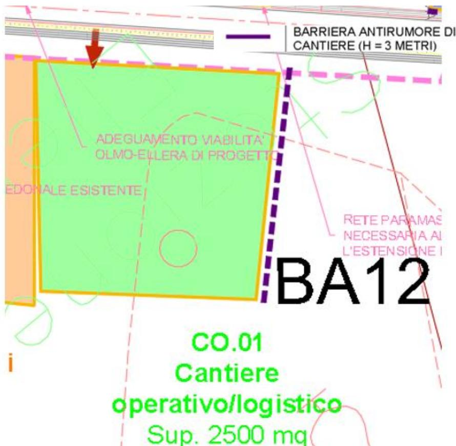
*Figura 6-24 CO.01 Ubicazione planimetrica della barriera antirumore/antipolvere di cantiere*
