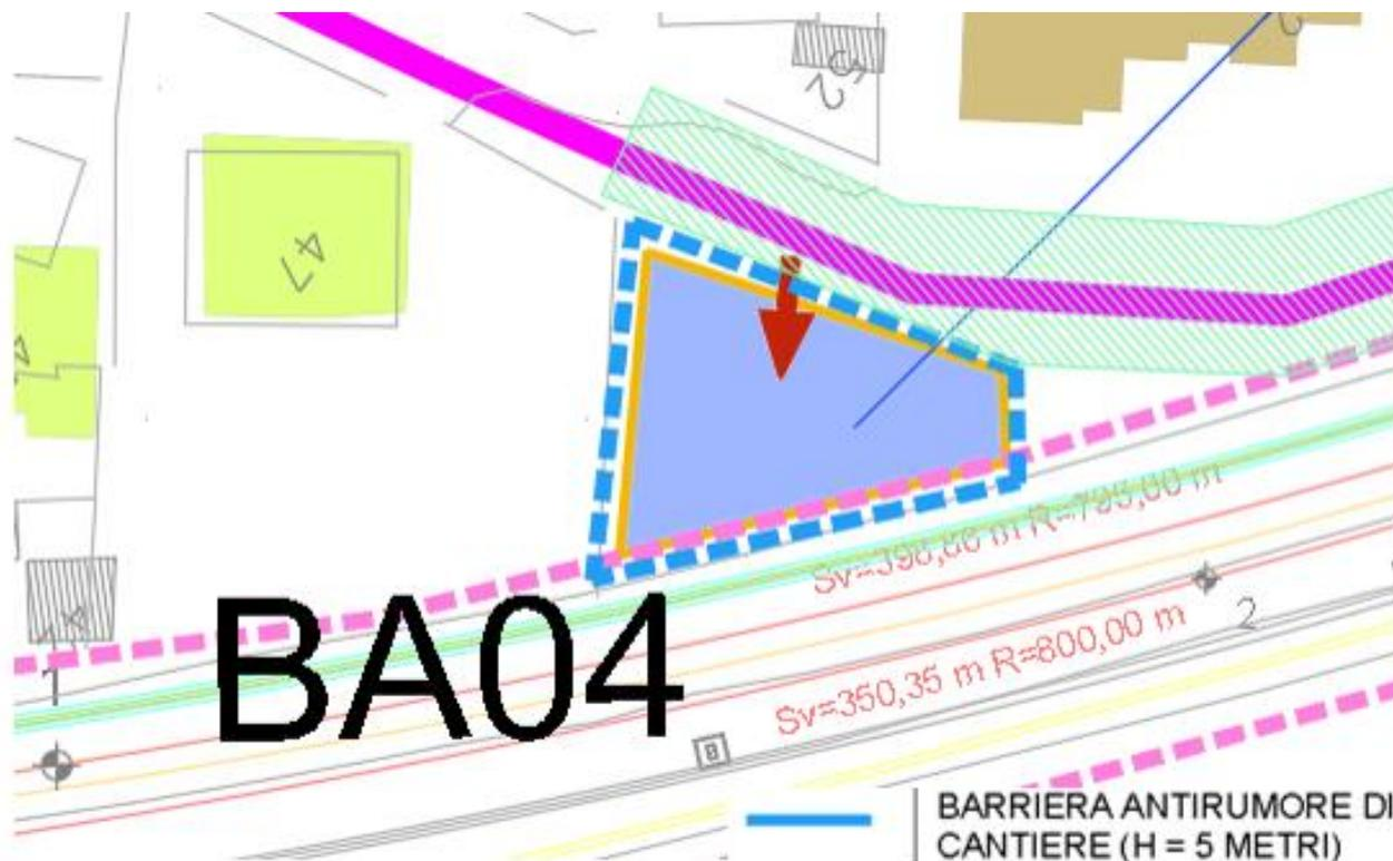
*Figura 6-5 AT.03 Ubicazione planimetrica della barriera antirumore/antipolvere di cantiere*
