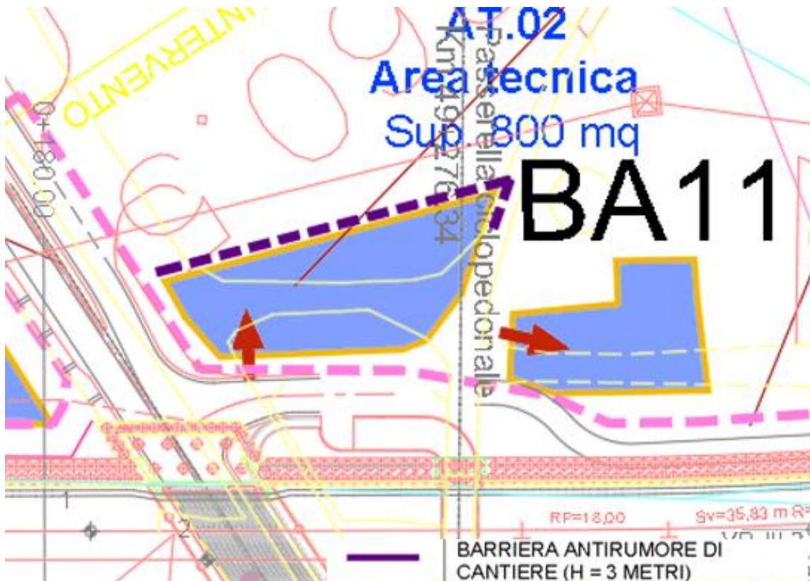
Figura 6-16 Figura 6-17 – AT.02 Ubicazione planimetrica della barriera antirumore/antipolvere di cantiere
