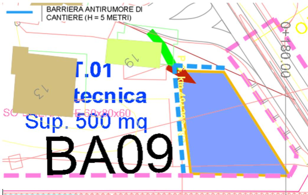
Figura 6-14 AT.01 Ubicazione planimetrica della barriera antirumore/antipolvere di cantiere
