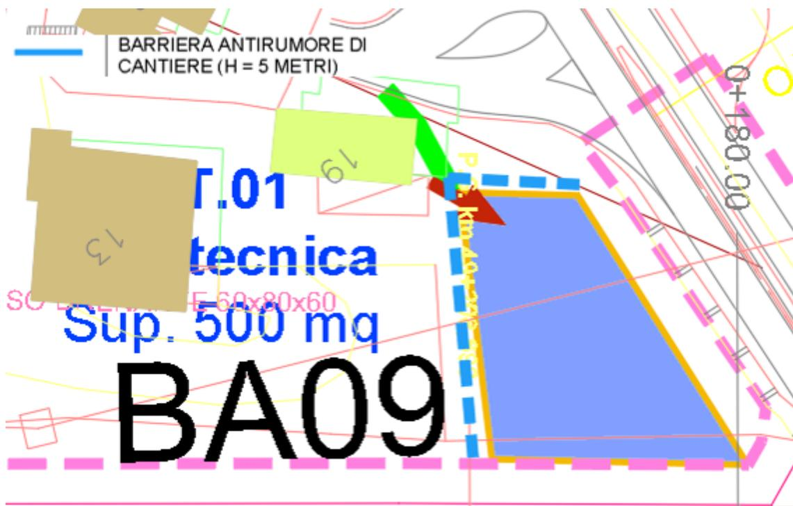
*Figura 6-19 AT.01 Ubicazione planimetrica della barriera antirumore/antipolvere di cantiere*
