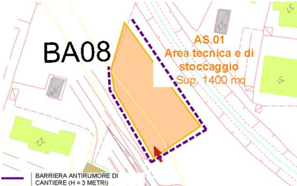
Figura 6-26 AS.01 Ubicazione planimetrica della barriera antirumore/antipolvere di cantiere
