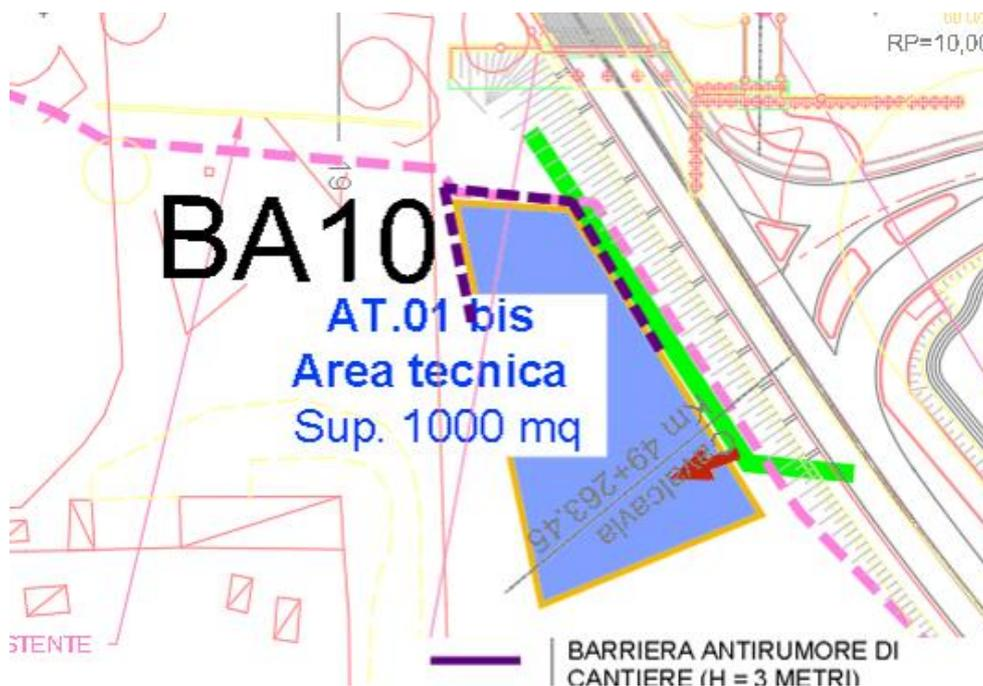
Figura 6-15 – AT.01 bis Ubicazione planimetrica della barriera antirumore/antipolvere di cantiere
