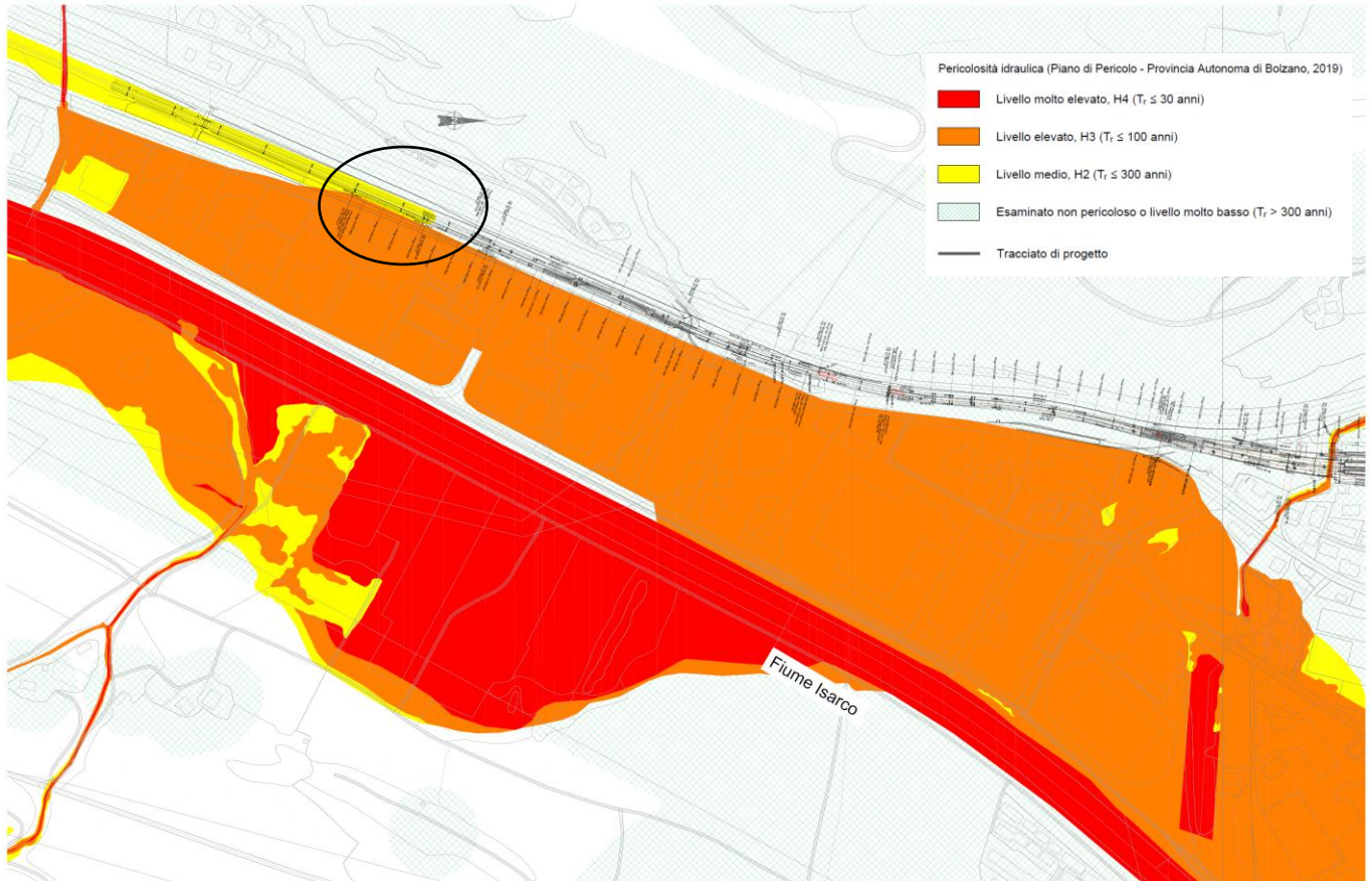
Figura 2 – Fiume Isarco: aree di pericolosità idraulica (fonte: Piano delle zone di pericolo della Provincia Autonoma di Bolzano) nel tratto in direzione Bolzano/Verona (da pk 0+000 a pk 0+590).
