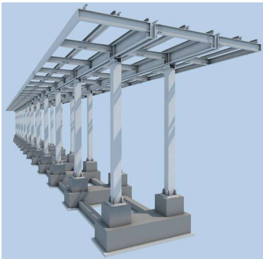
Figura 8.28: Pensiline – Vista 3D pensilina a doppia falda
