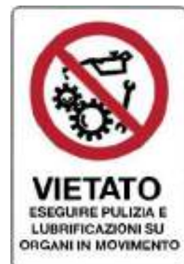
Vietato eseguire pulizia, riparazioni e lubrificazioni su organi in movimento
