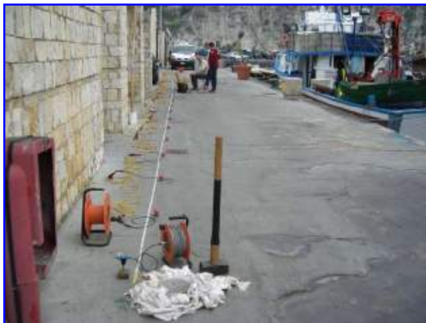
Foto 5 – Prospezione sismica MASW in corrispondenza dell'area progettuale lungo il molo i sopraflutto del porto.
