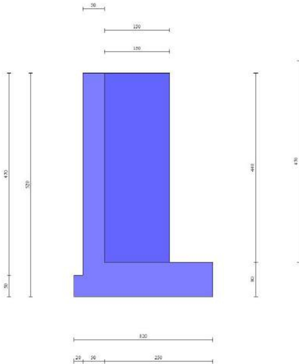
Fig. 1 - Sezione quotata del muro
