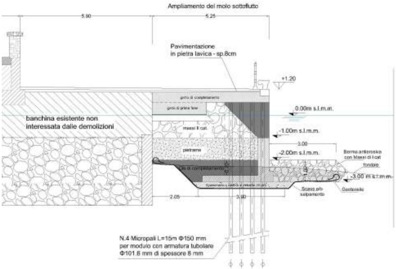
Figura 1- Sezione di progetto ampliamento molo di sottoflutto tipologia 1 con piano di posa -3m s.l.m.m. (Moduli A)
