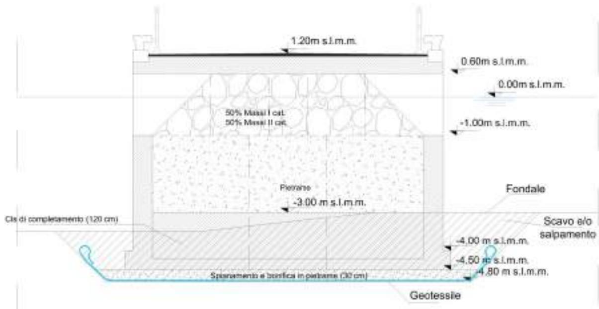
Fig. 5- Sezione trasversale tipo allungamento
