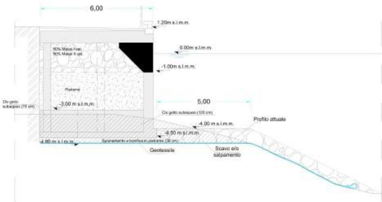
Fig. 6- Sezione longitudinale tipo allungamento
