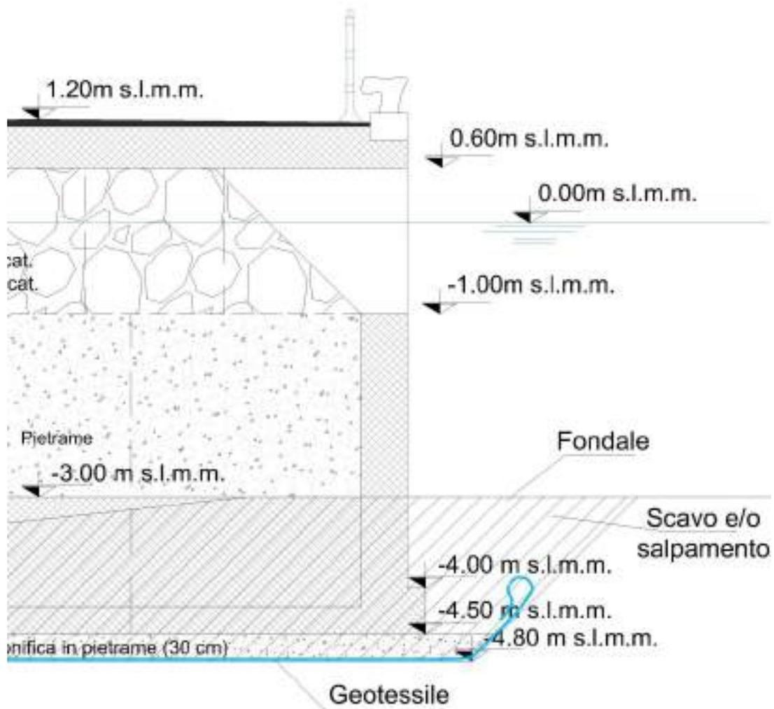
Figura 3- Sezione di progetto allungamento molo sottoflutto tipologia 3 con piano di posa -4.5m s.l.m.m (moduli C,C1,D,D1)
