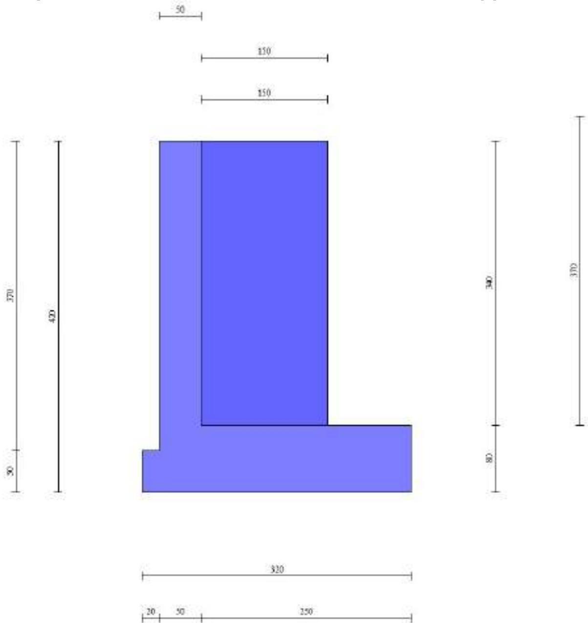
Fig. 1 - Sezione quotata del muro
