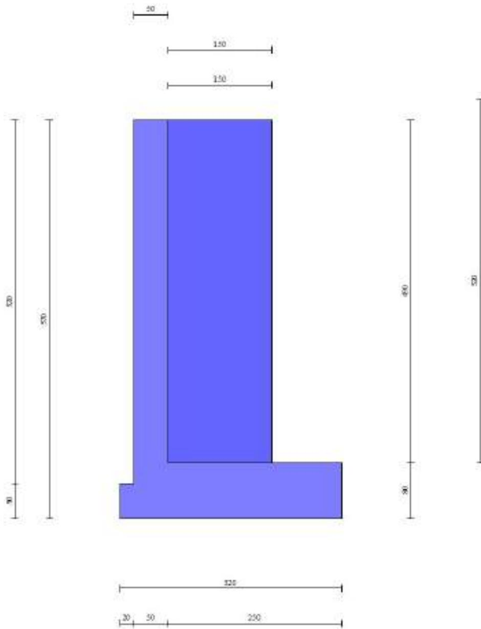
Fig. 1 - Sezione quotata del muro
