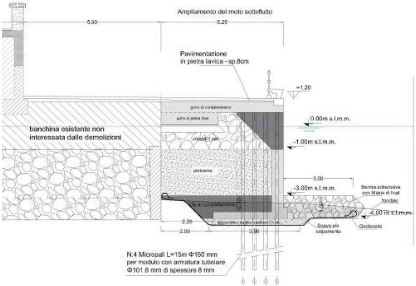
Figura 2- Sezione di progetto ampliamento sottoflutto tipologia 2 con piano di posa -4m s.l.m.m (Moduli B)
