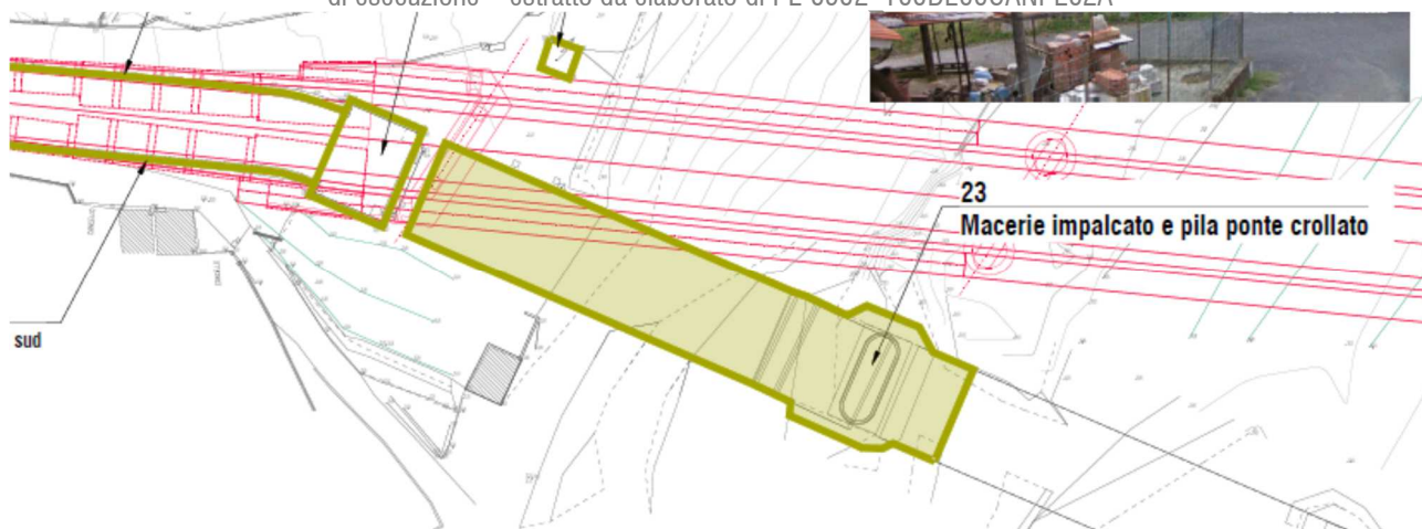
Figura 4 – Stralcio planimetrico con sovrapposizione delle macerie e del ponte di progetto (in rosso). In giallo il tratto di macerie da rimuovere per la realizzazione del nuovo ponte. Intervento incluso nel progetto “Nuovo ponte” ed in parte già eseguito – estratto da elaborato di PE 0902_T00DE00CANPLO1A
