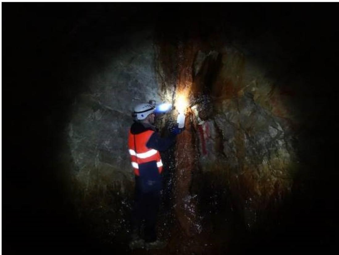
*Figura 118 - Campionamento delle acque all'interno della galleria Riso Parina (Pk 11+000) su cui eseguire le analisi geochimiche in laboratorio e misura di portata.*
