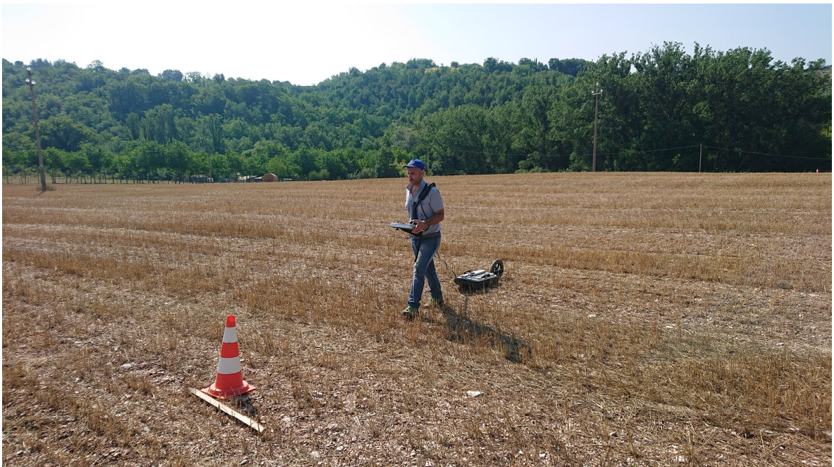
Fig 9) Area 1. Esecuzione delle misure georadar.
