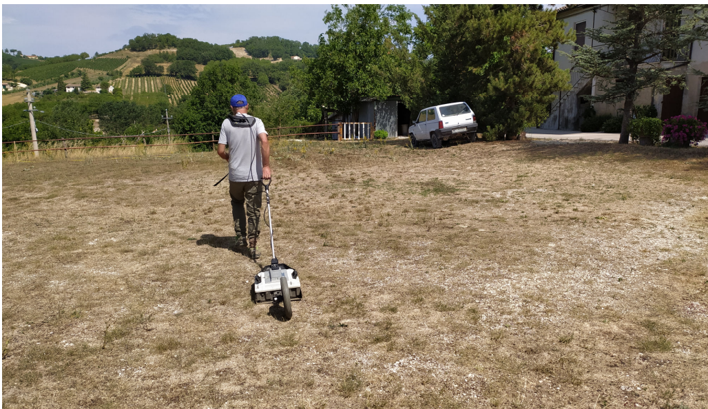
Fig 4) Esecuzione delle indagini georadar nell'area di Matelica
