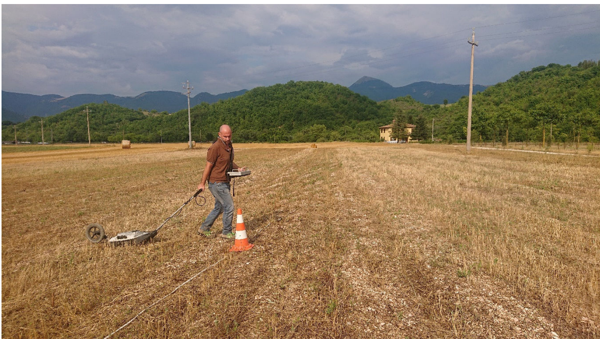
Fig 10) Superficie terrazzata dell'Area di Argignano. Esecuzione delle scansioni con georadar.
