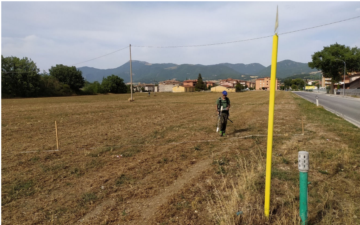
Fig. 7) Esecuzione delle misure magnetiche. Evidenti i pali metallici del metanodotto e di due cavidotti presenti lungo la fascia di indagine.
