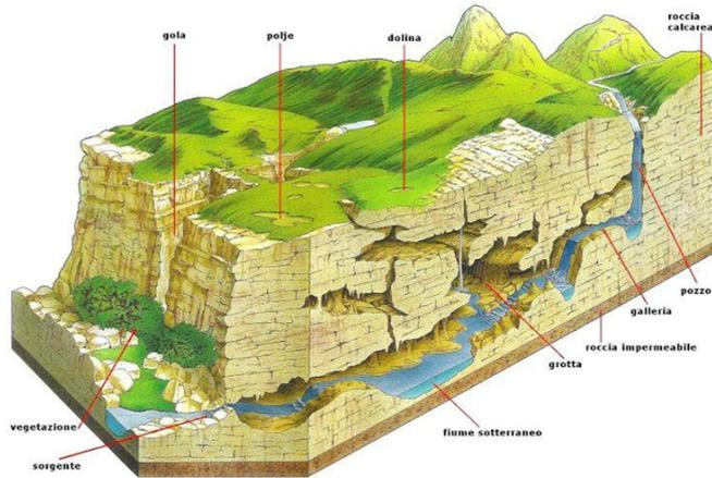
**Fig. 4.4.4a:** Esempi delle principali strutture derivanti dal carsismo.
