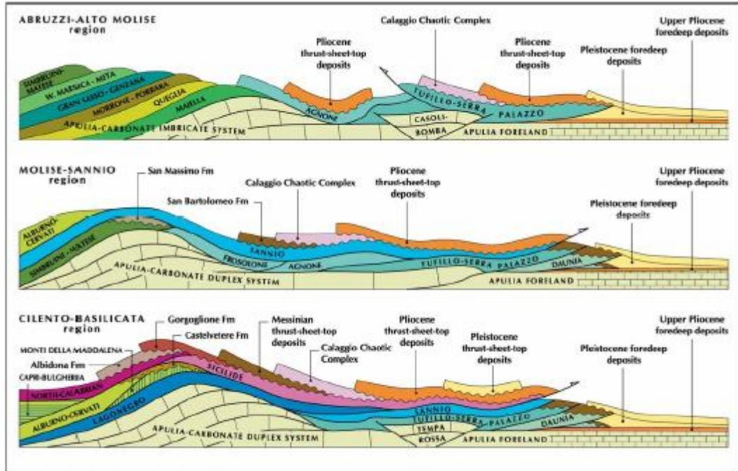
**Fig. 4.4.3b:** Rappresentazione schematica dei rapporti strutturali fra le varie unità tettoniche costituenti il dominio della catena dell'Appennino Meridionale (Patacca & Scandone, 2007). Il profilo di interesse è il secondo, nel quale si vedono le unità del Sannio sovrascorse al di sopra del sistema a "duplex" dei carbonati del dominio apulo.
